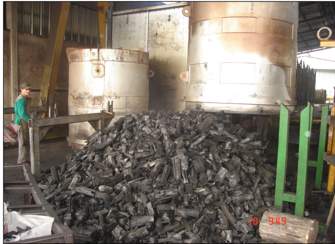
FIGURA 21: DESCARGA DO CILINDRO APÓS A CARBONIZAÇÃO
