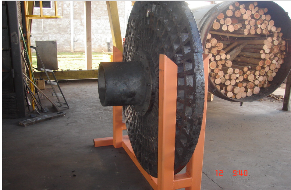
FIGURA 16: VISTA DA GRELHA METÁLICA COM A CHAMINÉ
