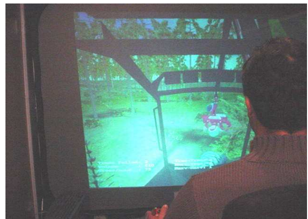
FIGURA 12 – SIMULADOR DE REALIDADE VIRTUAL ORYX HARVESTER
