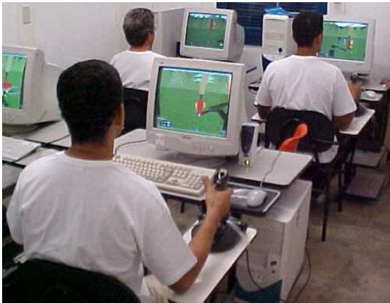
FIGURA 11 – SIMULADOR DE REALIDADE VIRTUAL SIMLOG FORWARDER
