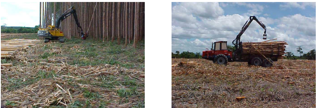
FIGURA 20 – OPERAÇÃO DE CAMPO HARVESTER E FORWARDER.
