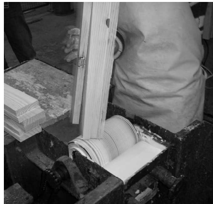
FIGURA 9 - APLICAÇÃO SEMI-MECANIZADA DE ADESIVO PVAc FONTE: O autor (2007)
