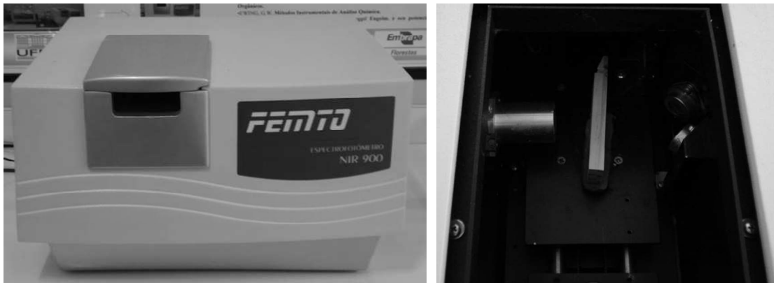
FIGURA 13 - (A) ESPECTROFOTÔMETRO FEMTO NIR 900 E (B) AMOSTRA POSICIONADA PARA AVALIAÇÃO DO ESPECTRO FONTE: O autor (2008)
