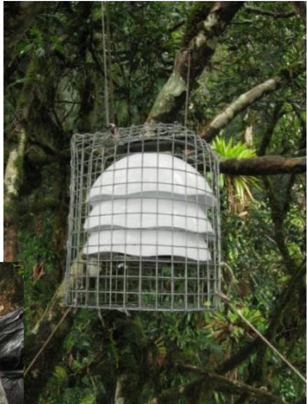
Registrador com abrigo e grade protetora, aos 1.000 m s.n.m.
