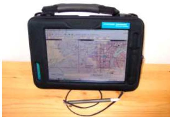
**FIGURA 7** – *Tablet* PC adotado para as campanhas aéreas usando a tecnologia LAED
