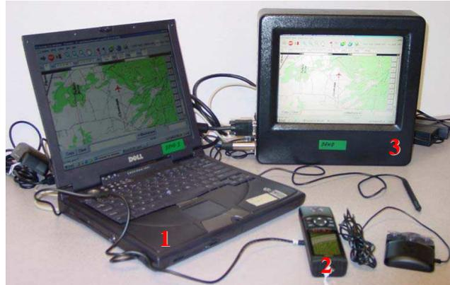
**FIGURA 6** – Sistema baseado em um *notebook* (1), modelo Dell 8000 PC, com aparelho receptor GPS Garmin 12XL (2), e *tablet touch screen* da marca KDS (3)
