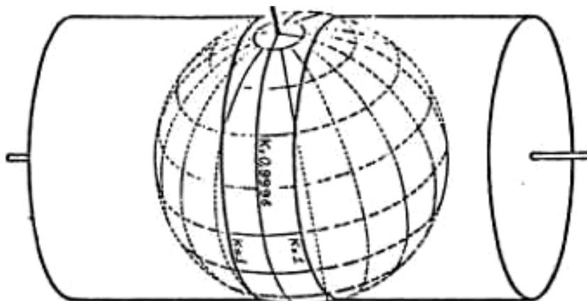
**FIGURA 10** – Esquema ilustrativo da Projeção UTM
