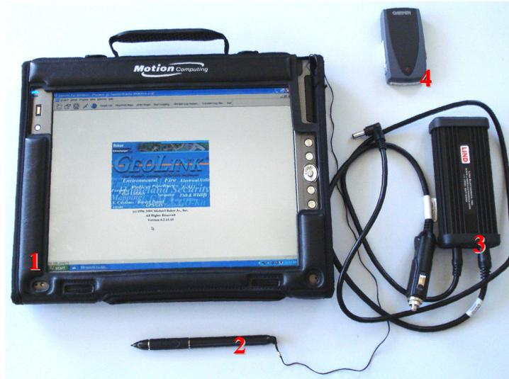
**FIGURA 15** – Conjunto de equipamentos utilizados para adaptação do LAED às condições brasileiras: *tablet PC* (1); caneta óptica (2); alimentador via tomada 12V (3); GPS Garmin 10 com transmissão de dados por sistema *Bluetooth* (4)
