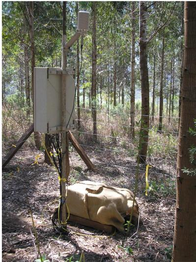
FIGURA 8 – ESTAÇÃO METEOROLÓGICA E CAIXA METÁLICA COM O SISTEMA DE ARMAZENAMENTO DOS DADOS
