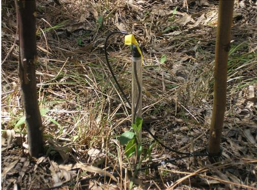
FIGURA 4 – TENSÍÔMETRO INSTALADO À 30CM DE PROFUNDIDADE NO SOLO
