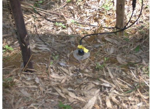
FIGURA 5 – TENSÍÔMETRO INSTALADO À 60CM DE PROFUNDIDADE NO SOLO
