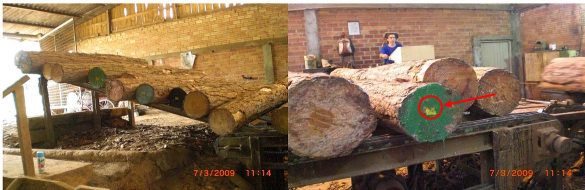
FIGURA 11 - TORAS MARCADAS E PINTADAS NO TOPO DA MESA DE ALIMENTAÇÃO DA SERRA PRINCIPAL
