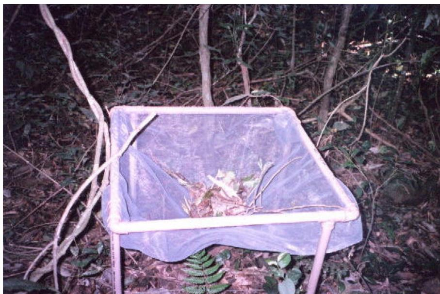
**FIGURA 9** – Coletor utilizado para a serapilheira depositada
