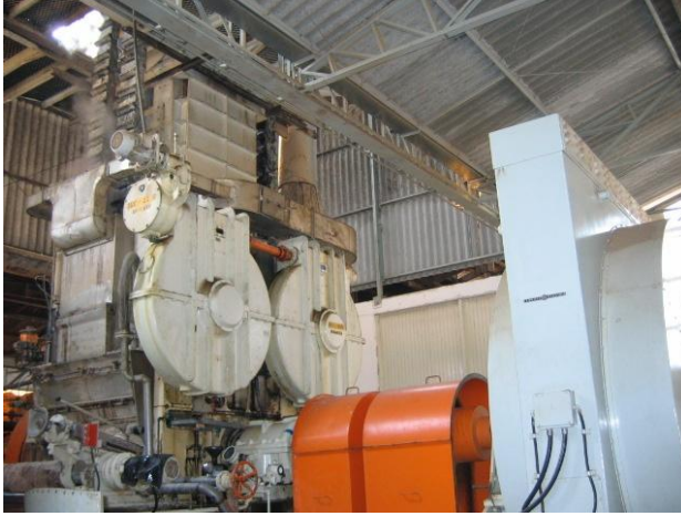
FIGURA 75 – Desfibrador FONTE: SANTOS (2012)
