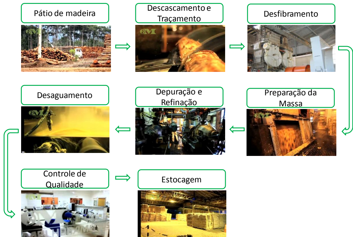
FIGURA 74 – Principais etapas do processo de produção da pasta TGW. FONTE: SANTOS (2012)
