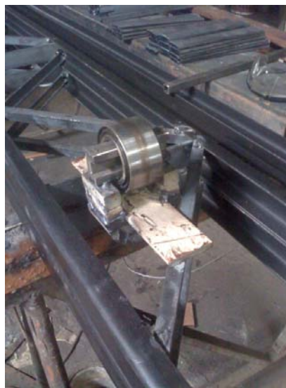
Ilustração 23 - Rolamento da traquitana instalado no seu eixo Fonte : Arquivo pessoal
