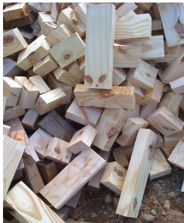
Ilustração 8 - Trechos com defeitos retirados das lâminas de madeira.
