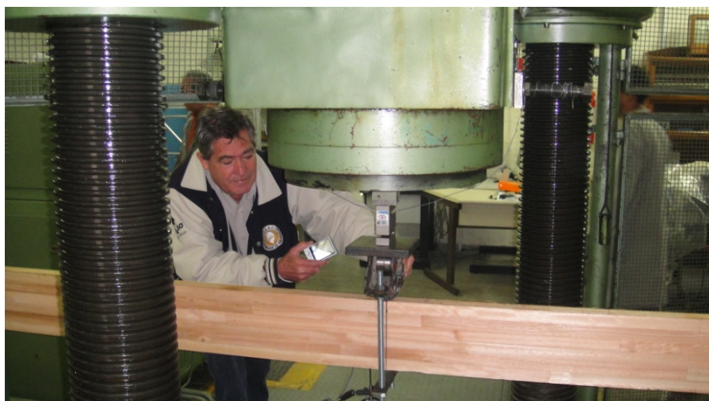
Ilustração 27 - Vista lateral da “traquitana” e respectiva braçadeira, sem dispositivo de retenção lateral, sendo instalada abaixo da célula de carga na viga a ser ensaiada com L_1=300 cm
