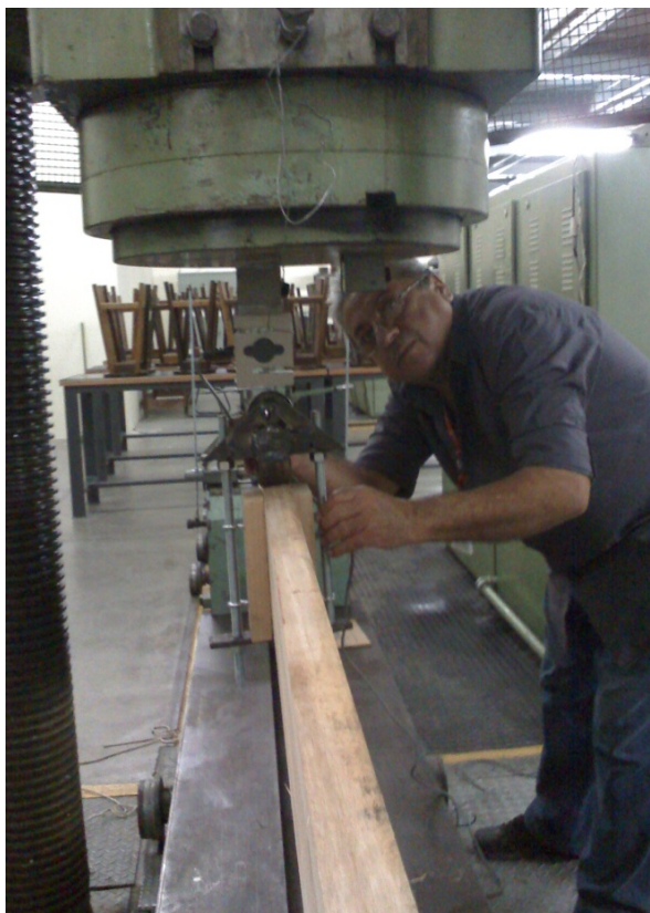
Ilustração 26 - Vista frontal da traquitana e respectiva braçadeira, sem dispositivo de retenção lateral, sendo instalada abaixo da célula de carga na viga a ser ensaiada com L_1=300 cm
