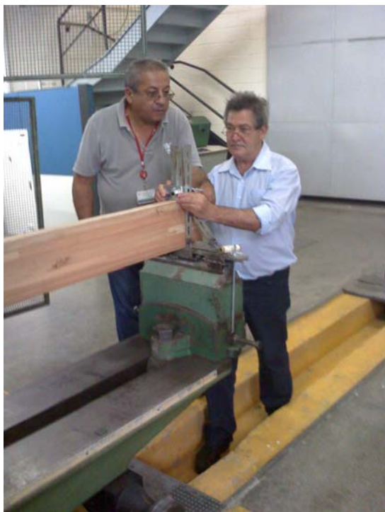
Ilustração 31 - Garfo totalmente solicitado, impedindo a torção da viga. Observar a deformação da viga por torção em relação ao cordão esticado
