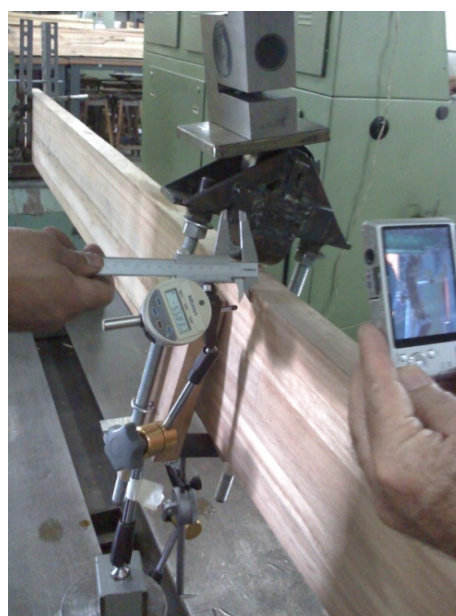
Ilustração 34 - Viga sujeita a instabilidade lateral. Detalhe da seção central torcida e seções dos apoios não
