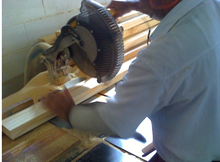
Ilustração 7 - Lâmina de Pinus sendo cortada para a retirada de um nó. Os pedaços remanescentes serão emendados para formar uma nova lâmina
