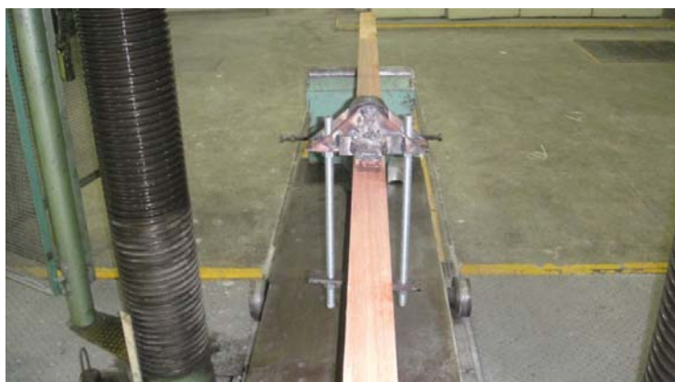
Ilustração 24 - A "traquitana" pronta, sem o dispositivo de retenção lateral, instalada sobre a viga a ser ensaiada Fonte : Arquivo pessoal
