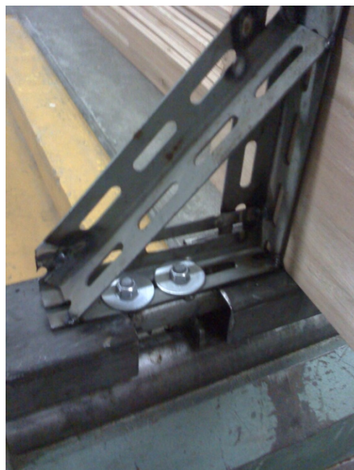
Ilustração 30 - Conjunto garfo móvel e respectiva mão francesa; perfil U de boca para baixo sobe o rolete da prensa
