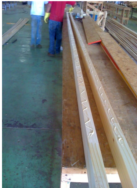
Ilustração 13 - Lâminas com cola para montar as viga
