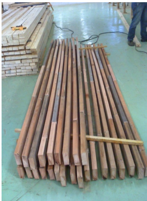
Ilustração 12 - Lâminas de Eucalipto formadas por vários pedaços colados entre si
