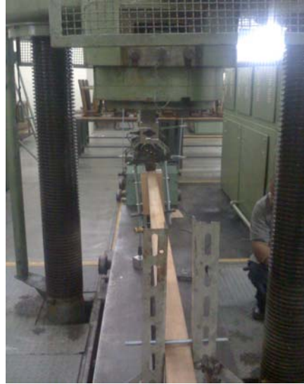
Ilustração 40 - Primeiro ensaio: viga carregada em processo de instabilidade
