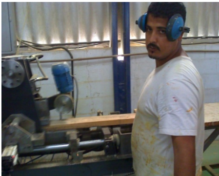
Ilustração 16 - Máquina para execução de acabamento (plaina e lixa)
