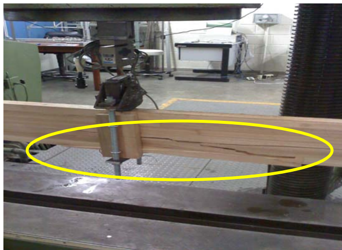
Ilustração 42 - Segundo ensaio: viga rompida sem sofrer instabilidade
