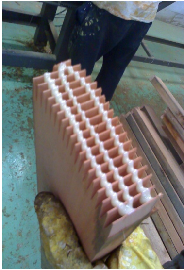
Ilustração 10 - Aplicação de cola (adesivo) na emenda, finger joint, pronto para prensagem
