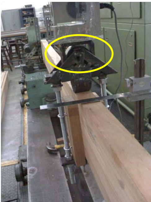
Ilustração 41 - Dispositivo adaptado ao cutelo, para impedir deslocamento lateral
