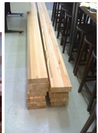
Ilustração 18 - Vigas em MLC, lixadas, prontas para o utilização
