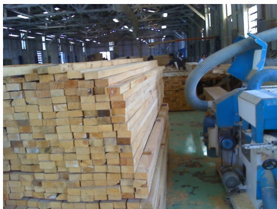
Ilustração 6 - Madeira de Pinus seca em estufa no interior da fábrica, a espera para retirada dos trechos com imperfeições Local: Terreno da sede da empresa CG Sistemas Construtivos - Suzano – SP Fonte: Arquivo pessoal
