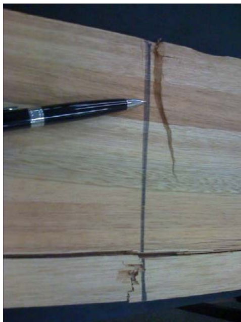
Ilustração 36 - Vista da seção central da viga com ( L_1=150 cm), com marca de ruptura por compressão na porção superior, junto a marca do cutelo, e ruptura frágil por tração na porção inferior Fonte: Arquivo pessoal
