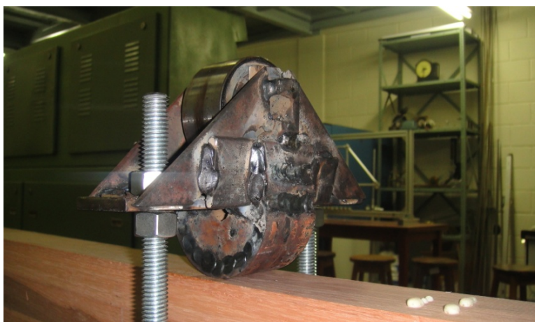
Ilustração 25 - Detalhe do rolete móvel lateral e do cutelo fixo circular no sentido longitudinal da viga Fonte : Arquivo pessoal
