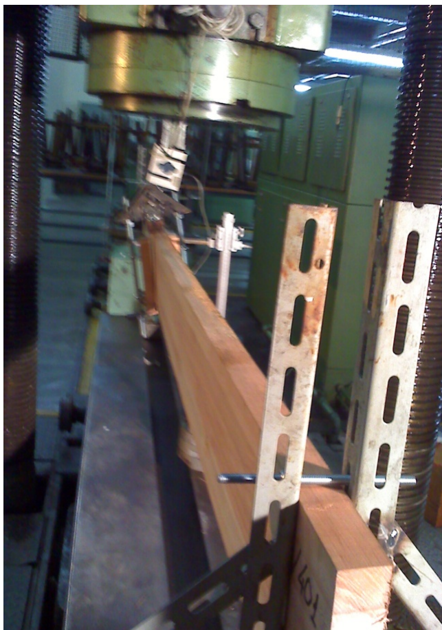
Ilustração 35 - Vista da viga durante ensaio de instabilidade lateral, apresentando torção na seção central
