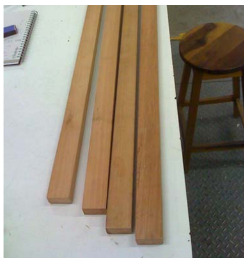
Ilustração 37 - Trechos de lâminas retirados das partes intactas das vigas sem emendas nas lâminas Fonte: Arquivo pessoal
