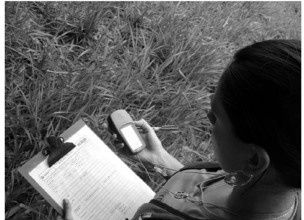
Figura 8: Coleta as coordenadas UTM com GPS de navegação.
