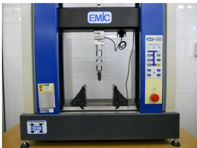
FIGURA 7 - EQUIPAMENTO EMIC COM ACESSÓRIOS PARA ENSAIO DE FLEXÃO
