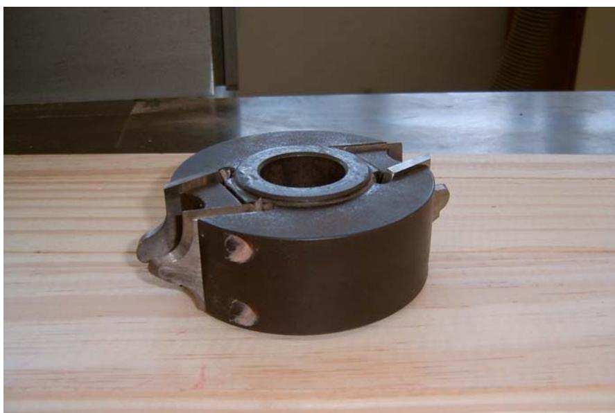
FIGURA 17 – FACA PERFILADA USADA NA OPERAÇÃO DE MOLDURA DE TOPO.
