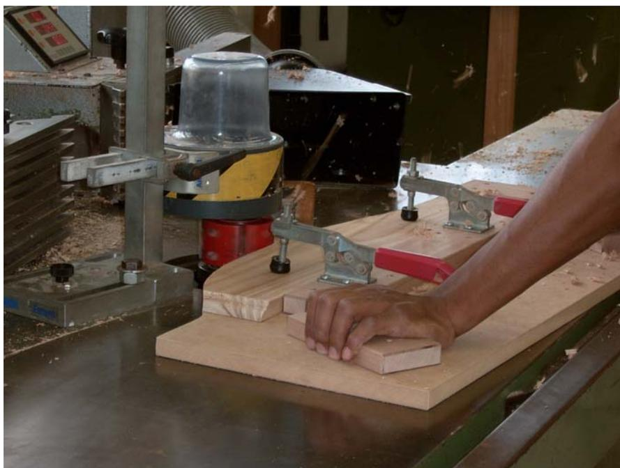
FIGURA 18 - OPERAÇÃO PERFILAGEM AXIAL SINUOSA.
