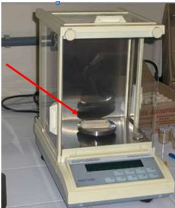
FIGURA 4 - BALANÇA DE PRECISÃO. A seta indica o modelo de barca de cerâmica utilizada no equipamento para a combustão total da amostra.
