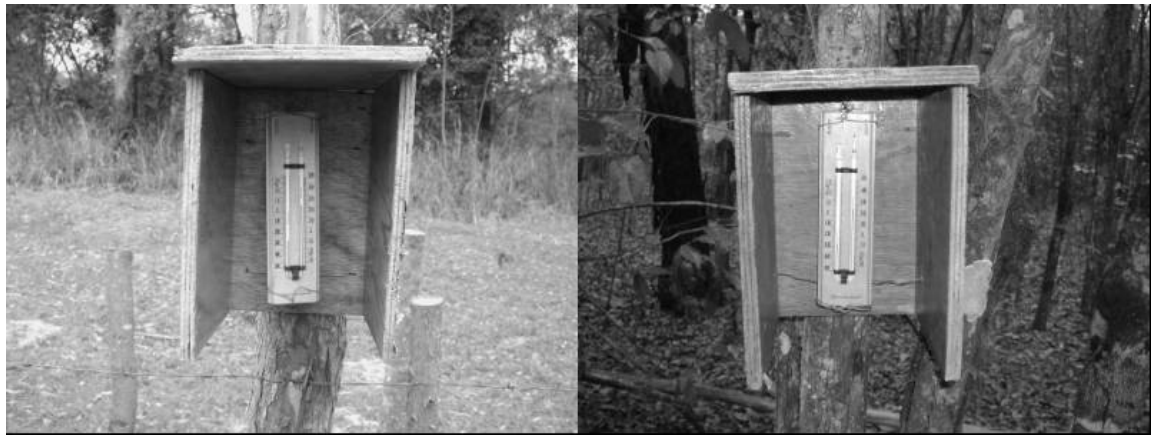
Figura 3. Termômetros instalados em cada campo de apodrecimento
