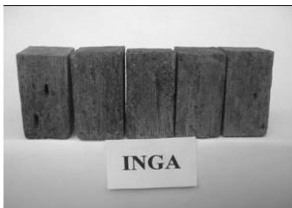
Figura 3 Corpos-de-prova de I. marginata , expostos a C. gestroi
