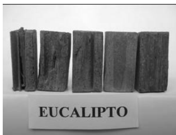
Figura 2 Corpos-de-prova de E. urophylla expostos à C. gestroi
