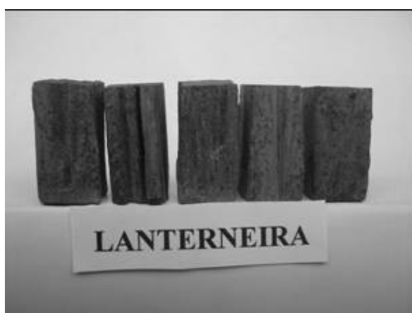
Figura 1 Corpos-de-prova de L. lactescens , expostos à C. gestroi .
