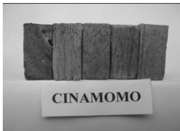
Figura 4 Corpos-de-prova de M. azedarach , expostos a C. gestroi
