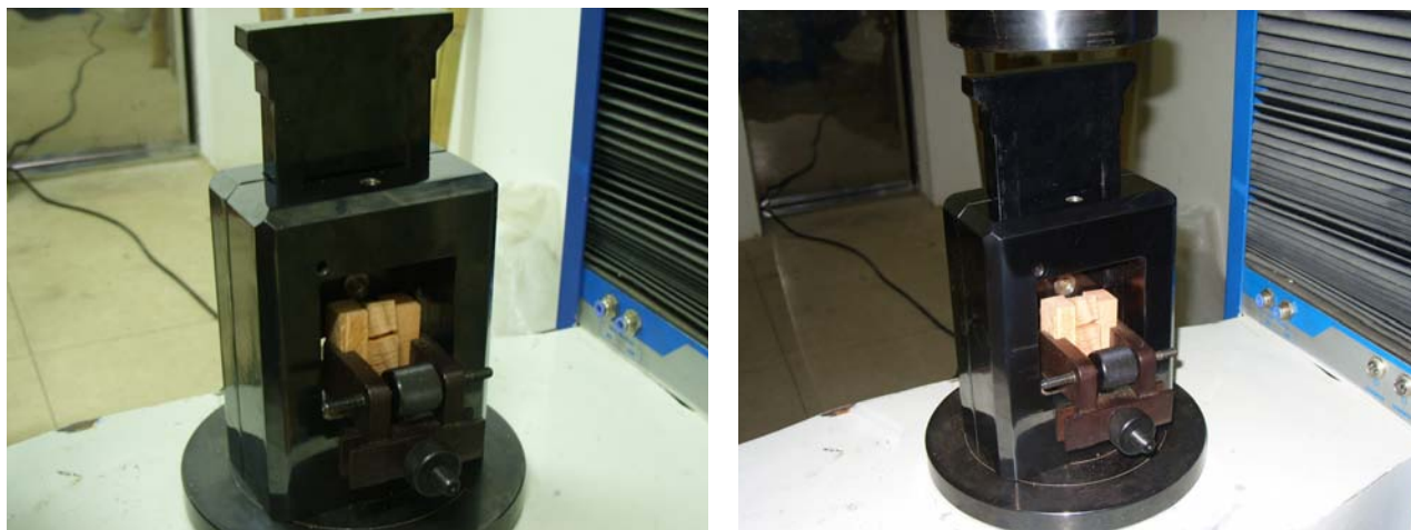
Figura 15. Detalhes dos ensaios de cisalhamento.
