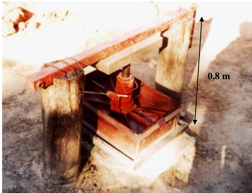
Figura 1. Macaco hidráulico e fôrma metálica para a confecção dos blocos com dimensões de 60 x 40 x 20 cm (comprimento x largura x altura)
