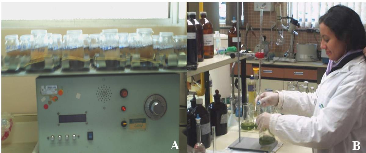
FIGURA 15 – A – ETAPA DE EXTRAÇÃO DO CARBONO MICROBIANO DAS AMOSTRAS, COM DETALHE DA FASE DE AGITAÇÃO MAGNÉTICA; B – ETAPA DE DETERMINAÇÃO DO CARBONO MICROBIANO ATRAVÉS DA TITULAÇÃO.
