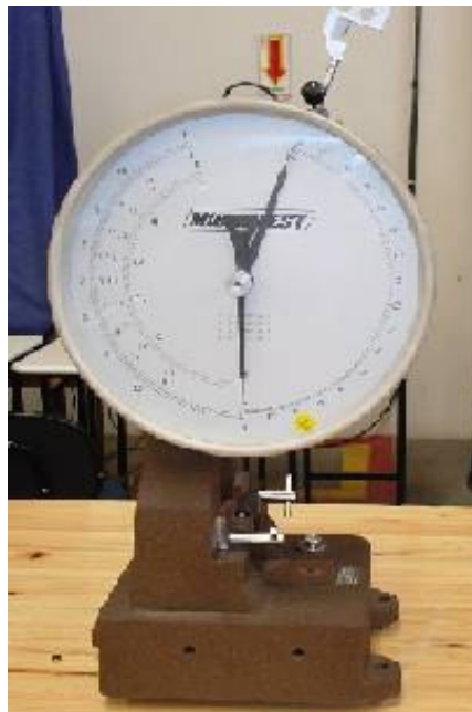
FIGURA 13 – EQUIPAMENTO PARA TESTE DE IMPACTO
