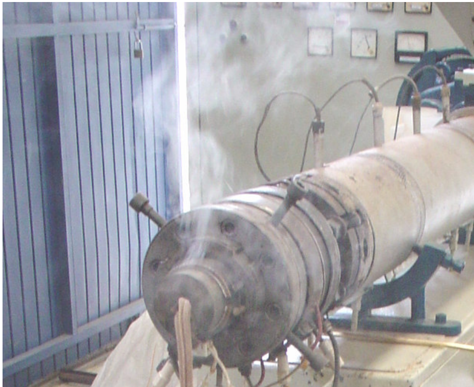
FIGURA 25 - LIBERAÇÃO DE GASES NA EXTRUSÃO REATIVA
