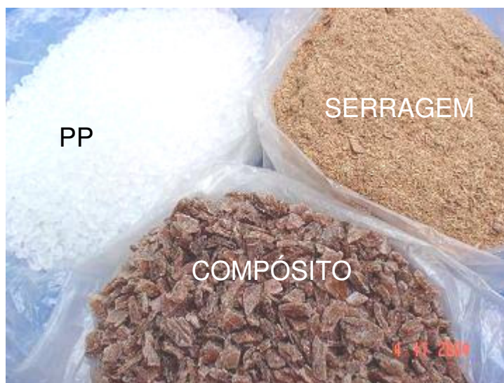
FIGURA 1 – COMPÓSITO PLÁSTICO-MADEIRA PRODUZIDO A PARTIR DO POLIPROPILENO (PP) VIRGEM E DA SERRAGEM
