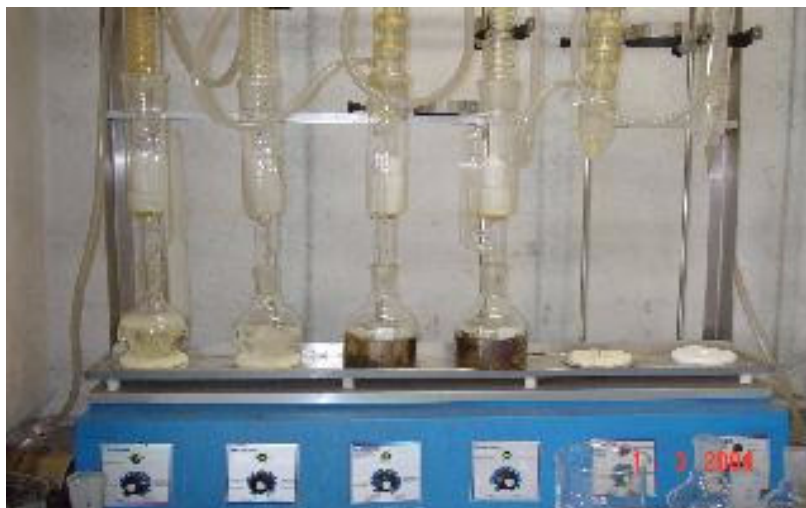
FIGURA 8 – APARELHO DE EXTRAÇÃO TIPO SOXHLET USADO NA DETERMINAÇÃO DE EXTRATIVOS DA MADEIRA
