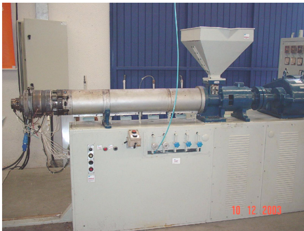
FIGURA 9 - EXTRUSORA MONORROSCA UTILIZADA NA PRODUÇÃO DOS COMPÓSITOS PLÁSTICO-MADEIRA
