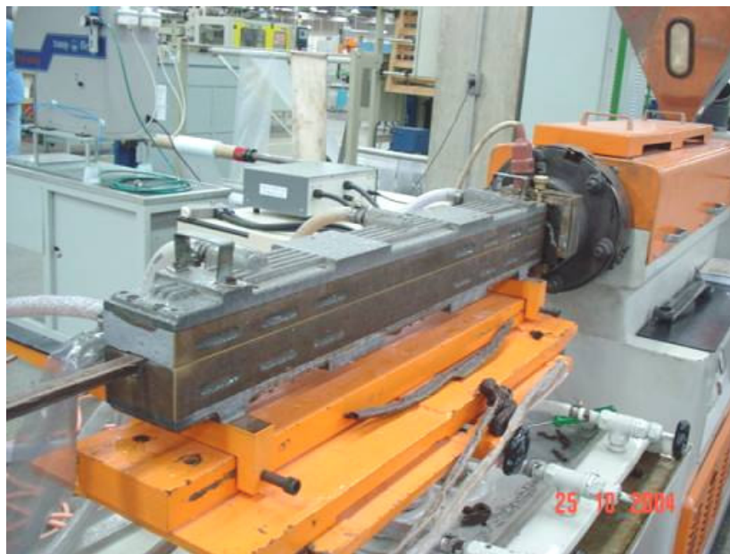
FIGURA 53 – PRODUÇÃO DE PERFIL USANDO COMPÓSITOS PLÁSTICO-MADEIRA EM UMA EXTRUSORA MONORROSCA
