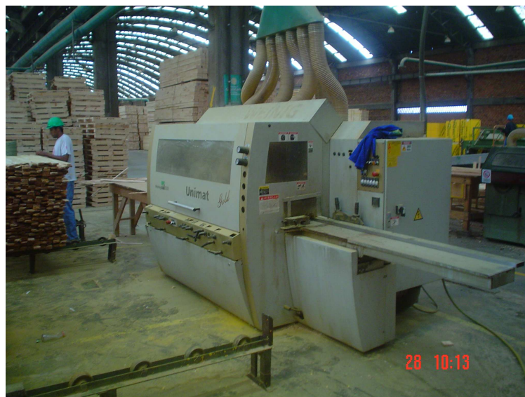
FIGURA 14 - PRÉ – BITOLAMENTO DAS PEÇAS DE MADEIRA SERRADA
