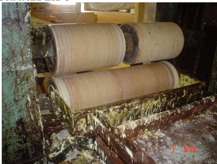
FIGURA 21 - APLICAÇÃO DO ADESIVO MELAMINA URÉIA FORMALDEÍDO
