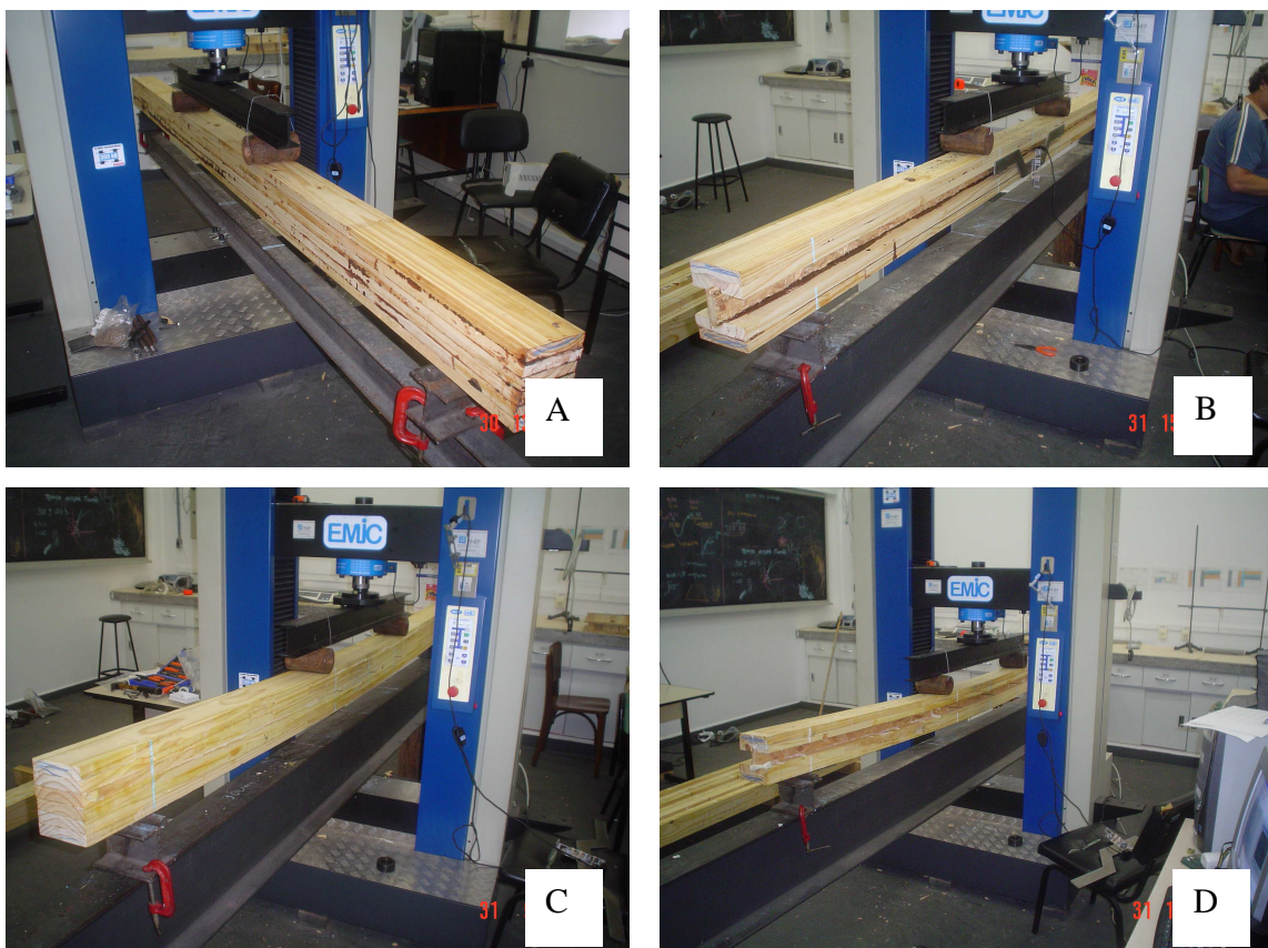
FIGURA 25 - VIGAS ESTRUTURAIS EM PROCESSO DE ENSAIO (A) e (B) Aplicação de Carga nas Vigas Estruturais; (C) e (D) Deformação das Vigas Estruturais.
