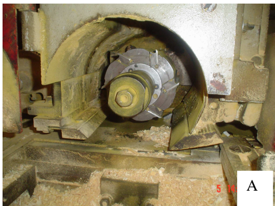
FIGURA 19 - FRESAMENTO DAS FLANGES E MONTAGEM DAS VIGAS EM I. (A) Fresas para Face Interna da Flange; (B) Junção da Flange e Alma.
