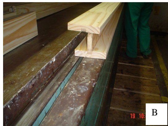
FIGURA 19 - FRESAMENTO DAS FLANGES E MONTAGEM DAS VIGAS EM I. (A) Fresas para Face Interna da Flange; (B) Junção da Flange e Alma.
