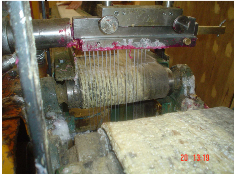
Figura 22 - APLICAÇÃO DO ADESIVO POLIURETANO
