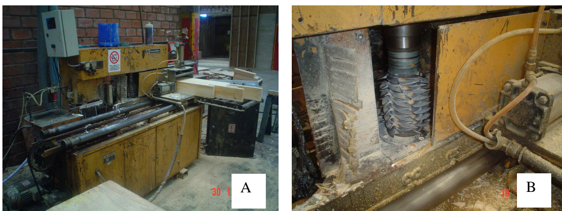
Figura 17 - PROCESSO DE FRESAMENTO DAS PEÇAS DE MADEIRA SERRADA (A) Passagem das Peças pela Fresadeira; (B) Conjunto de Dentes.
