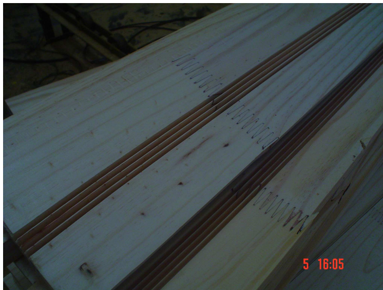
FIGURA 13 - FLANGE FRESADA PARA ENCAIXE DA ALMA DE OSB
