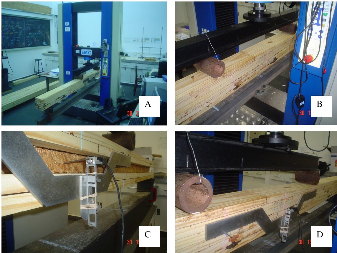
FIGURA 24 - VIGAS DE MLC E PERFIL I ENSAIADAS EM UMA MÁQUINA UNIVERSAL DE ENSAIOS, DETALHANDO OS APLICADORES DE CARGA E O DEFLECTÔMETRO. (A) Máquina de Ensaios; (B) Aplicação da Carga; (C) Detalhe do YOKE na Viga com Perfil I; (D) Detalhe do YOKE posicionado na viga MLC.
