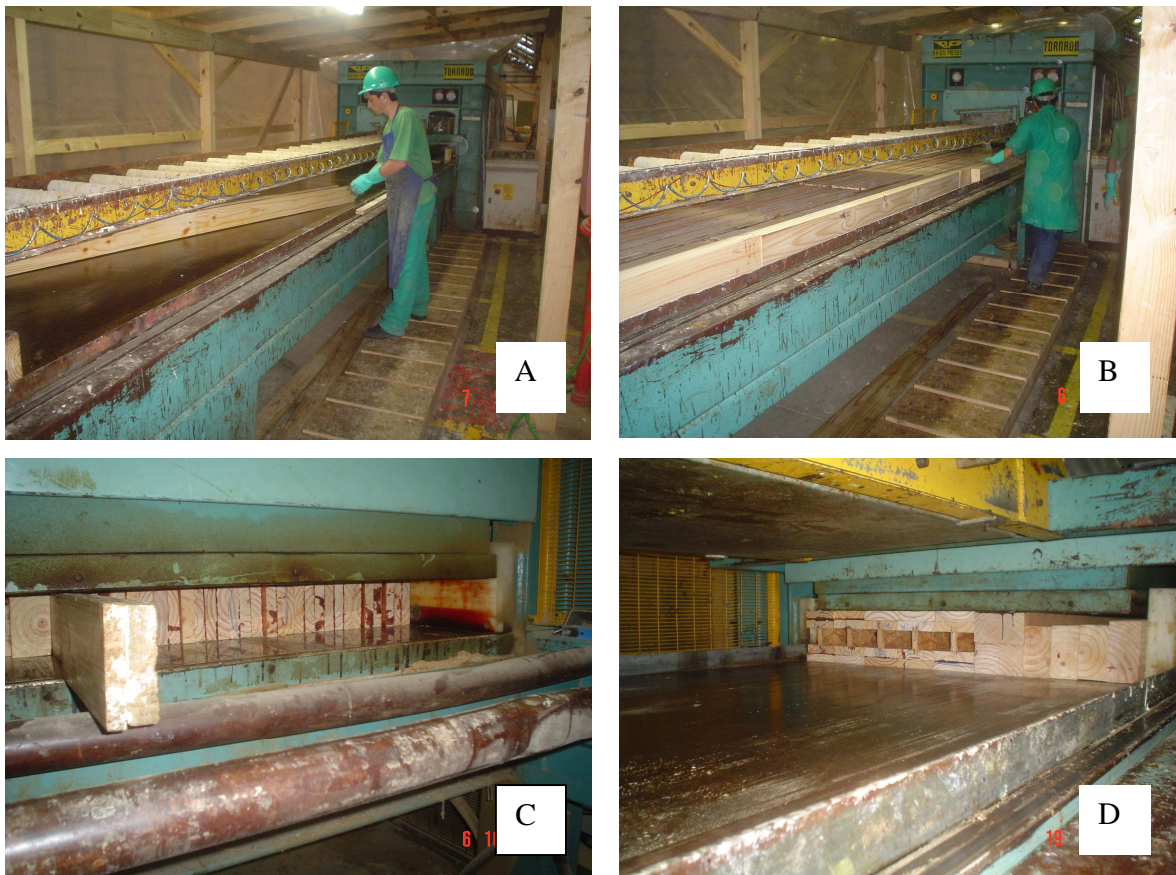
FIGURA 23 - CARREGAMENTO E PRENSAGEM DAS VIGAS NA PRENSA. (A) Disposição das vigas na Prensa; (B) Alimentação das Prensa com as Vigas; (C) Prensagem das vigas MLC; (D) Prensagem das vigas I.
