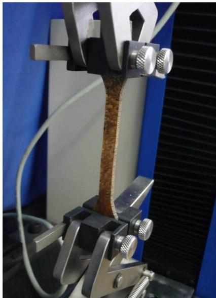
FIGURA 27 – ENSAIO DE TRAÇÃO DOS COMPÓSITOS
