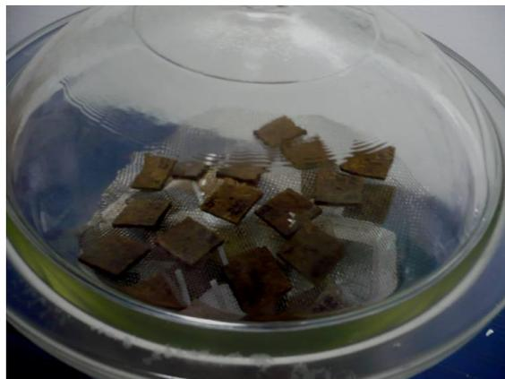
FIGURA 26 – CORPOS DE PROVA PARA O ENSAIO DE ABSORÇÃO DE UMIDADE A 75% ± 2%
