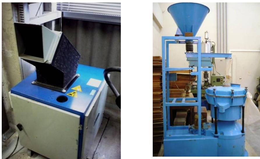
FIGURA 20 – MOINHO E PENEIRA UTILIZADOS PARA OBTER FIBRAS DE COCO
