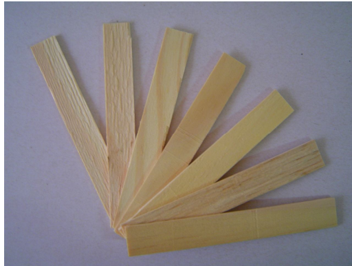
FIGURA 5. CORPOS-DE-PROVA CONFECCIONADOS COM DIMENSÕES 185 X 24 X 2 mm.
