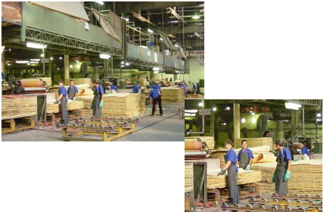
FIGURA 4. INDÚSTRIA DE COMPENSADOS E LAMINADOS LAVRASUL DETALHE, SISTEMA DE INSPEÇÃO DE QUALIDADE DE LÂMINAS VISUAL.
