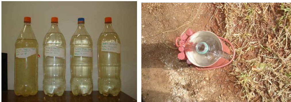
Amostrador utilizados para dois litros de amostra, e ao lado o coletor com os pesos.
