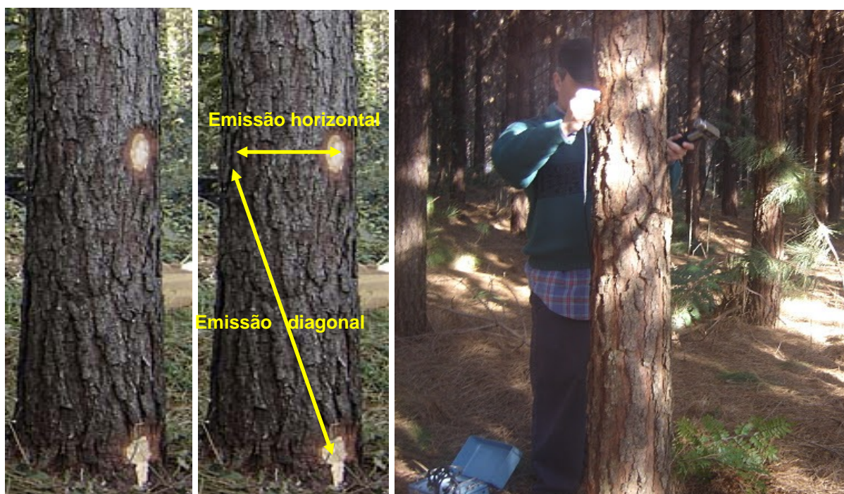
FIGURA 3.3 – ESQUEMA E APLICAÇÃO DAS ONDAS DE TENSÃO NAS ÁRVORES
