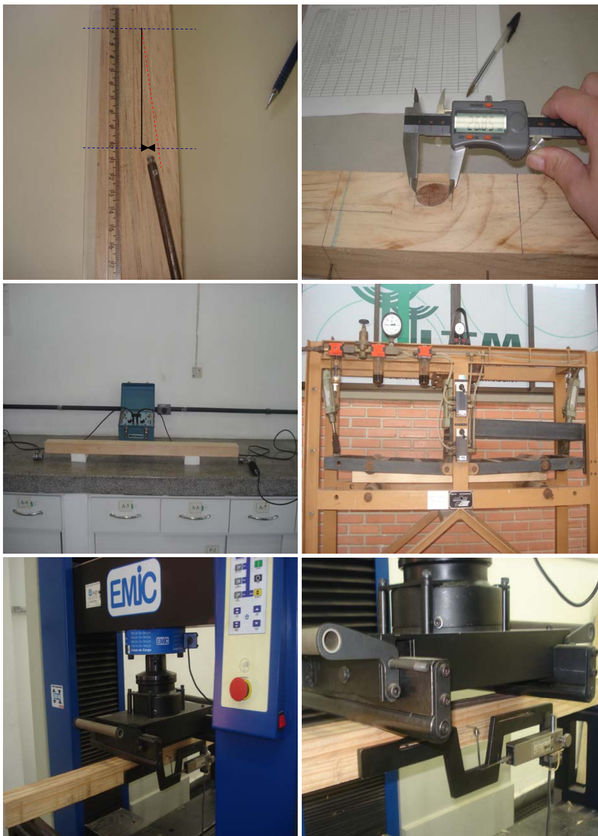
FIGURA 9.4 – MEDIÇÃO, ENSAIOS NÃO DESTRUTIVOS E ENSAIOS CONVENCIONAIS REALIZADOS NAS AMOSTRAS ESTRUTURAIS
