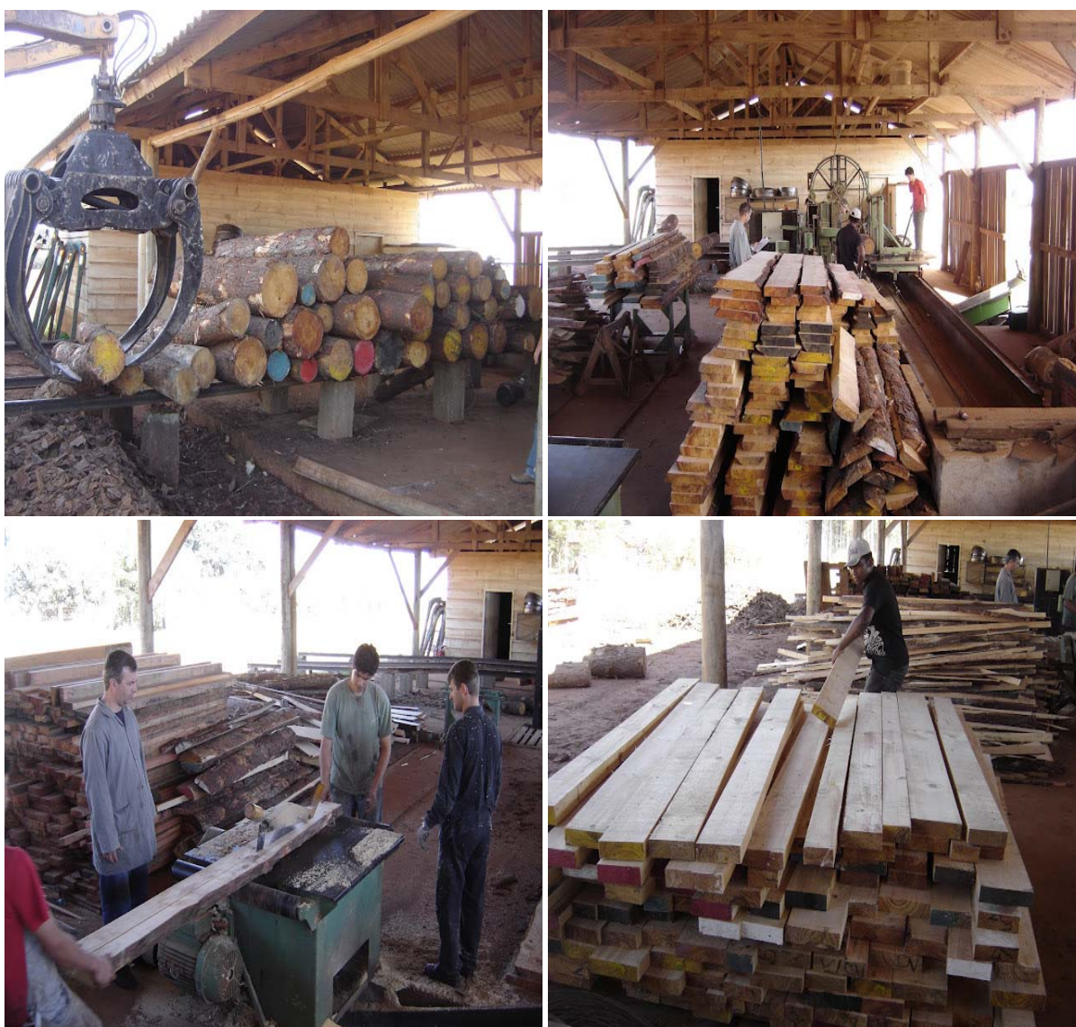
FIGURA 9.2 – DESDOBRO PRINCIPAL PARA OBTENÇÃO DAS PRANCHAS a) Seleção e identificação das toras; b) Desdobro principal; c) Refilagem das pranchas; d) Pranchas
