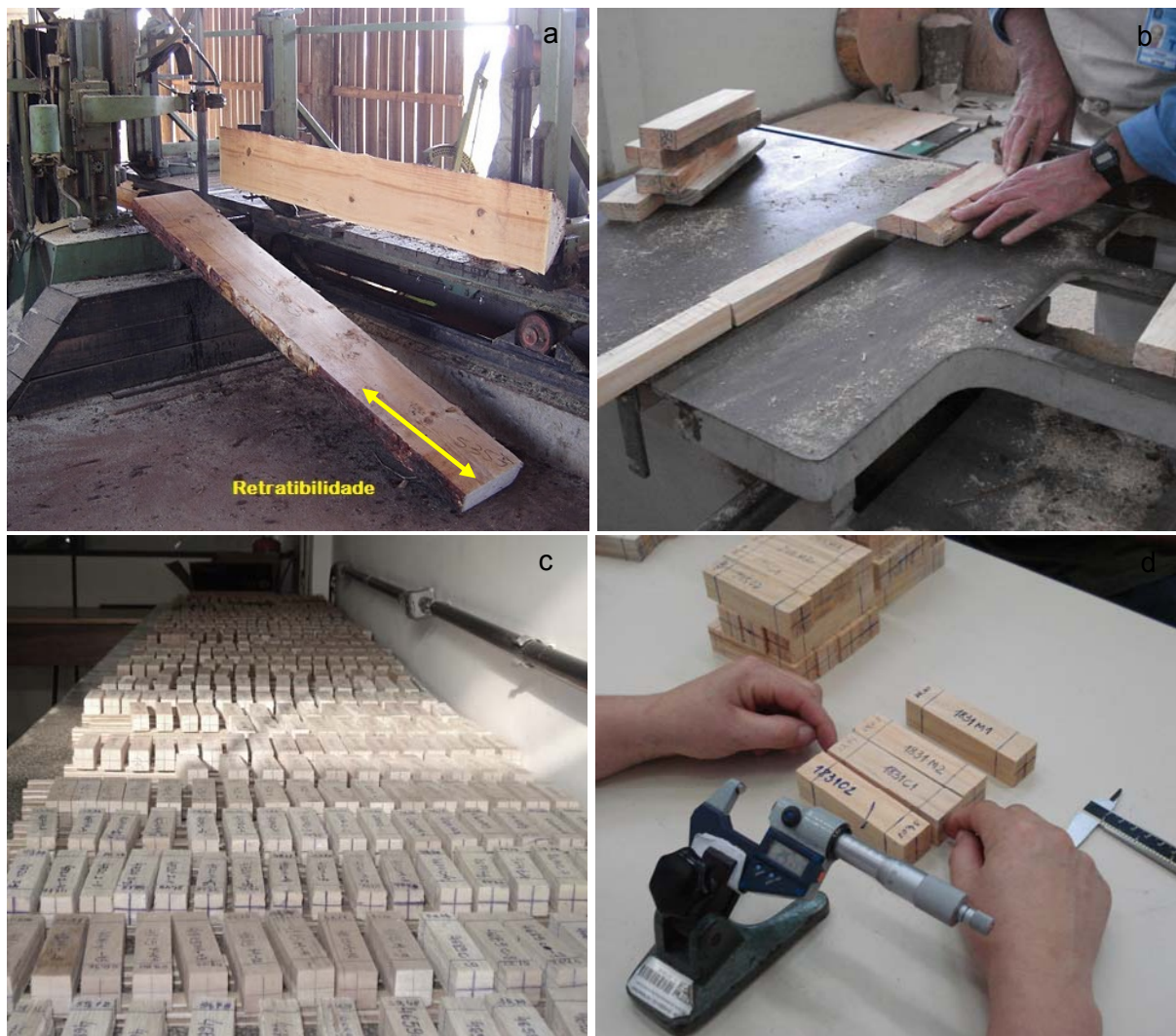
FIGURA 7.4 – ETAPAS DE DETERMINAÇÃO DA RETRATIBILIDADE
