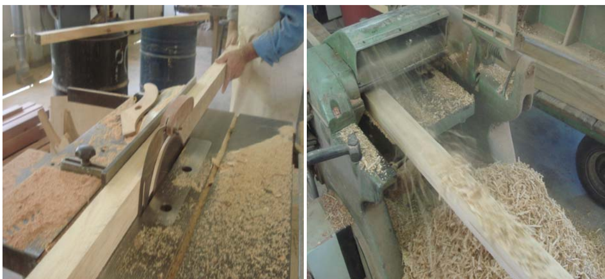
FIGURA 9.3 – CONFECÇÃO DAS AMOSTRAS ESTRUTURAIS (VIGAS)
