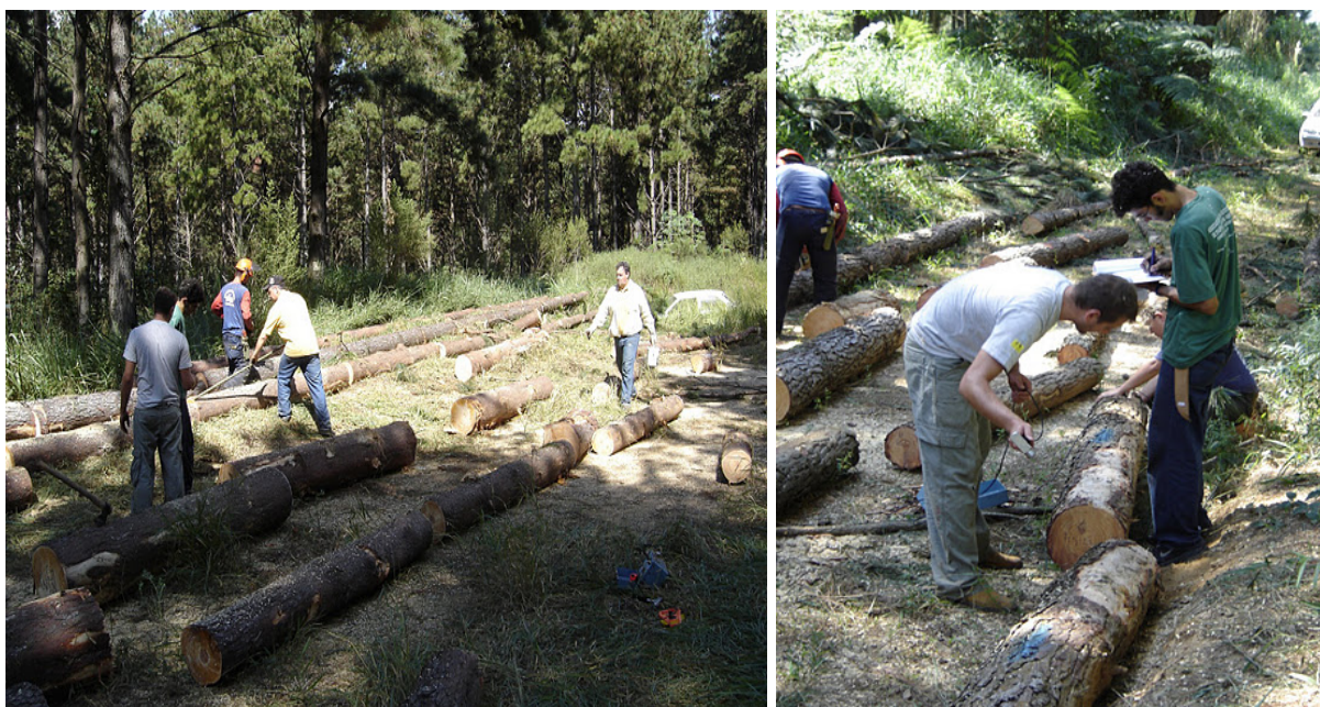
FIGURA 3.4 – APLICAÇÃO DAS ONDAS DE TENSÃO NAS TORAS
