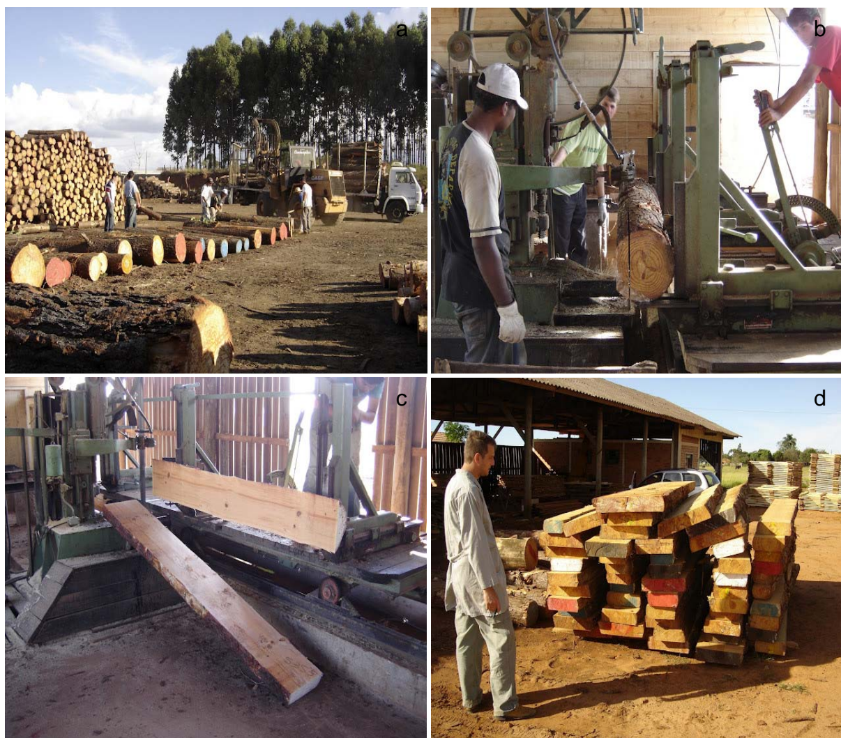
FIGURA 8.1 – PROCESSO DE IDENTIFICAÇÃO DAS TORAS E DESDOBRO a) Amostragem e seleção; b e c) Desdobro principal; d) Pranchões amostrados.
