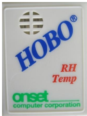
FIGURA 11 - REGISTRADOR MODELO HOBO® UTILIZADO NA PESQUISA FONTE: A autora (2012)
