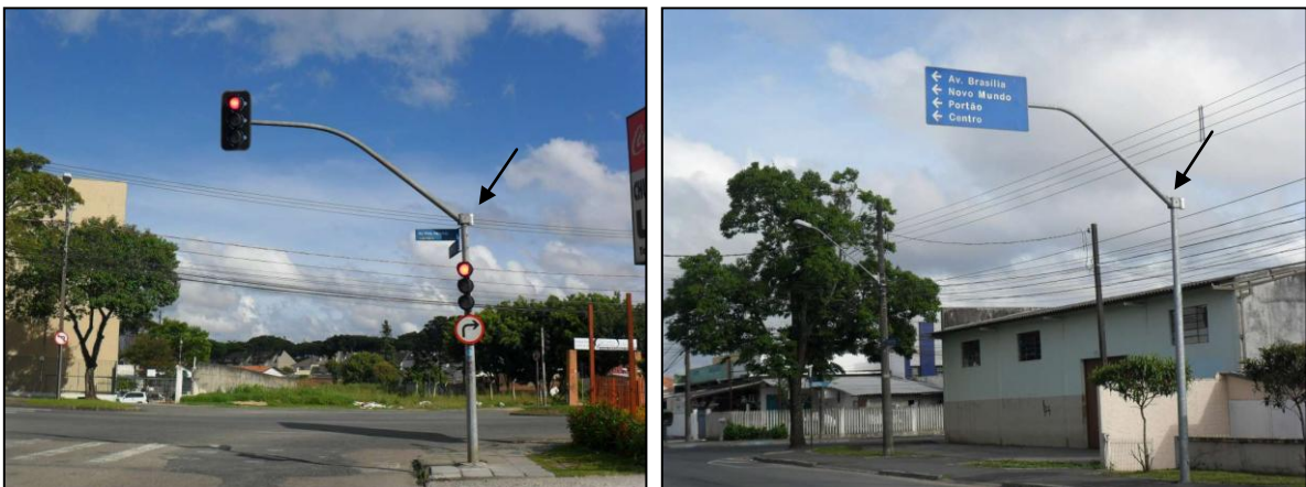
FIGURA 14 - EXEMPLOS DA INSTALAÇÃO DOS MINI-ABRIGOS METEOROLÓGICOS EM SINALEIROS E EM PLACAS DE SINALIZAÇÃO
