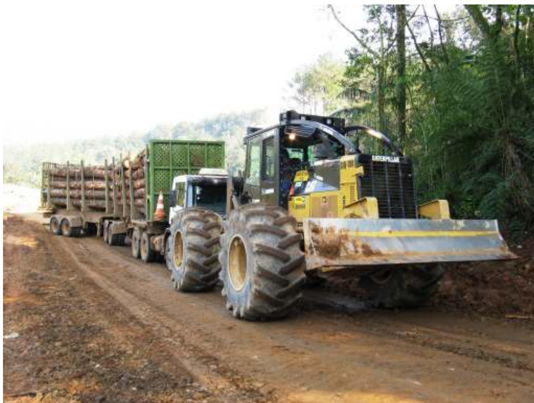
FIGURA 8: FOTO ILUSTRATIVA DE OPERAÇÃO DE APOIO COM TRATOR FLORESTAL TIPO SKIDDER Fonte: Klabin
