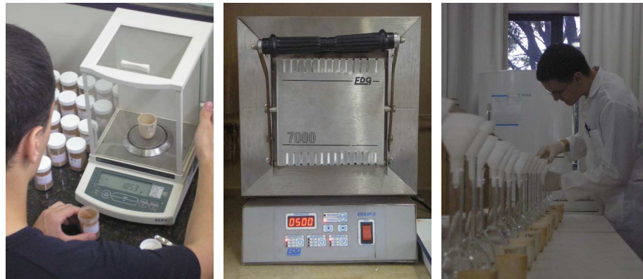
FIGURA 5 - DIFERENTES ETAPAS DA DIGESTÃO VIA SECA REALIZADA PARA DETERMINAÇÃO DOS NUTRIENTES. PESAGEM DAS AMOSTRAS A SEREM ANALISADAS, QUEIMA EM MUFLA (500°C) E FILTRAGEM DAS AMOSTRAS
