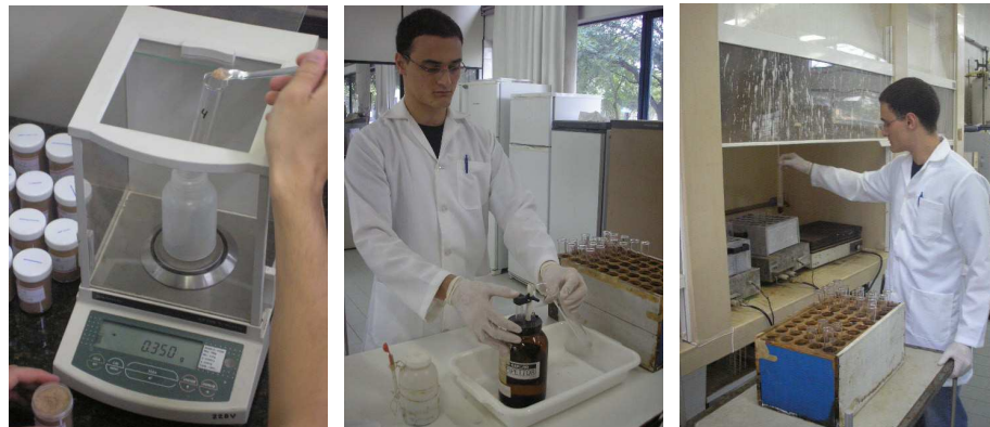
FIGURA 6 - DIFERENTES ETAPAS DA DIGESTÃO SULFÚRICA REALIZADA PARA DETERMINAÇÃO DO NITROGÊNIO. PESAGEM DAS AMOSTRAS A SEREM ANALISADAS, ADIÇÃO DO ÁCIDO SULFÚRICO E ALOCAÇÃO DAS AMOSTRAS NO BLOCO DIGESTOR
