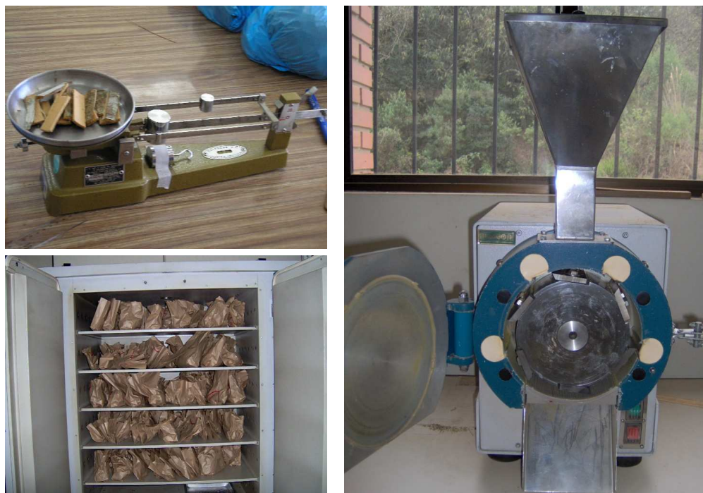
FIGURA 4 - PESAGEM DAS AMOSTRAS, SECAGEM EM ESTUFA DE VENTILAÇÃO FORÇADA (65°C) E MOAGEM NOS EQUIPAMENTOS E INSTALAÇÕES DA UFPR
