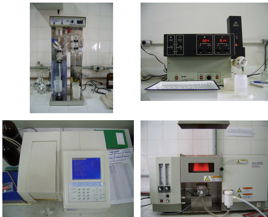
FIGURA 7 - DESTILADOR DE NITROGÊNIO E ESPECTROFOTÔMETROS UTILIZADOS PARA A DETERMINAÇÃO DOS NUTRIENTES
