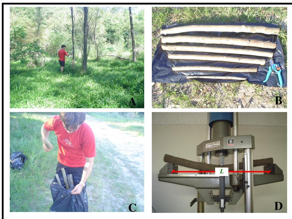
Figura 10 – Procedimentos efetuados desde a coleta dos caules até a realização dos testes mecânicos: A – seleção de exemplares de cada espécie; B – confecção de corpos-de-prova com diferentes dimensões; C – acondicionamento para evitar perda de umidade; D – máquina de ensaios utilizada para os testes de flexão estática, em que L = distância máxima entre apoios, ou seja, 100 cm (Fotos: Luciano Denardi).
