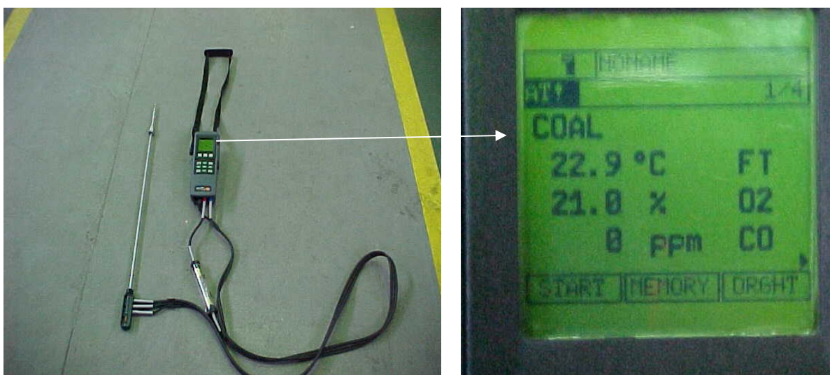
Figura 18. Equipamento TESTO 300 M and XL – Flue gas analyser utilizado para análise dos gases de combustão do simulador de injeção de finos de carvão.
