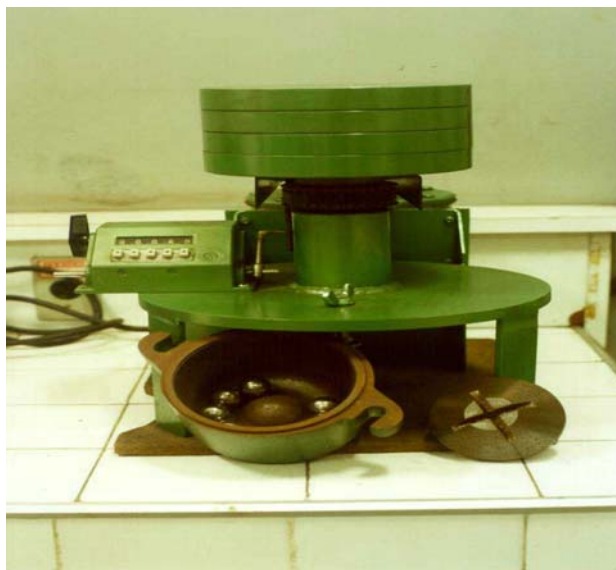
Figura 12. Moinho de esferas utilizado nos ensaios de moabilidade dos carvões. (NBR 8739, 1992)
