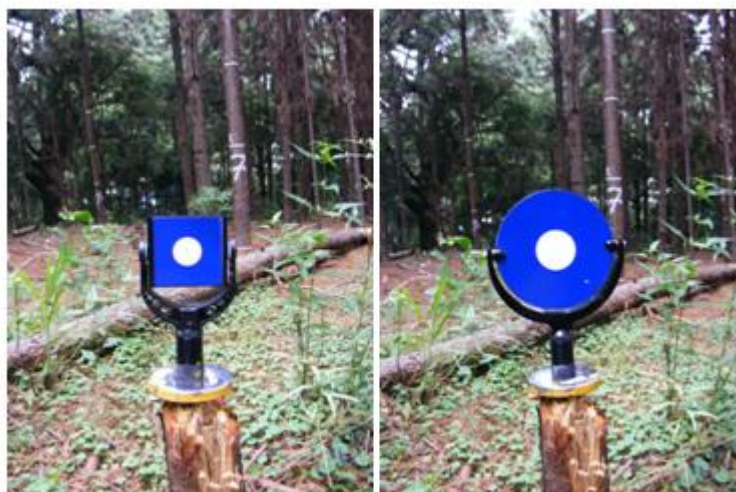
FIGURA 7 – ALVOS PLANO REFLETORES UTILIZADOS NO LEVANTAMENTO LASER FONTE: O Autor (2011).
