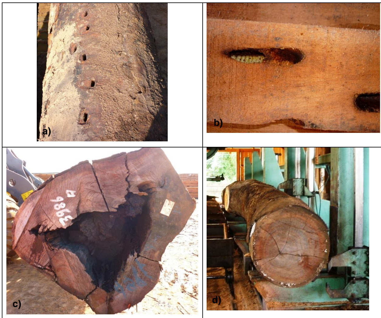
FIGURA 18 – Madeira de muracatiara: a) tora com ataque de brocas; b) tábuas com ataque de broca; c) presença de oco; d) toras tortuosas
