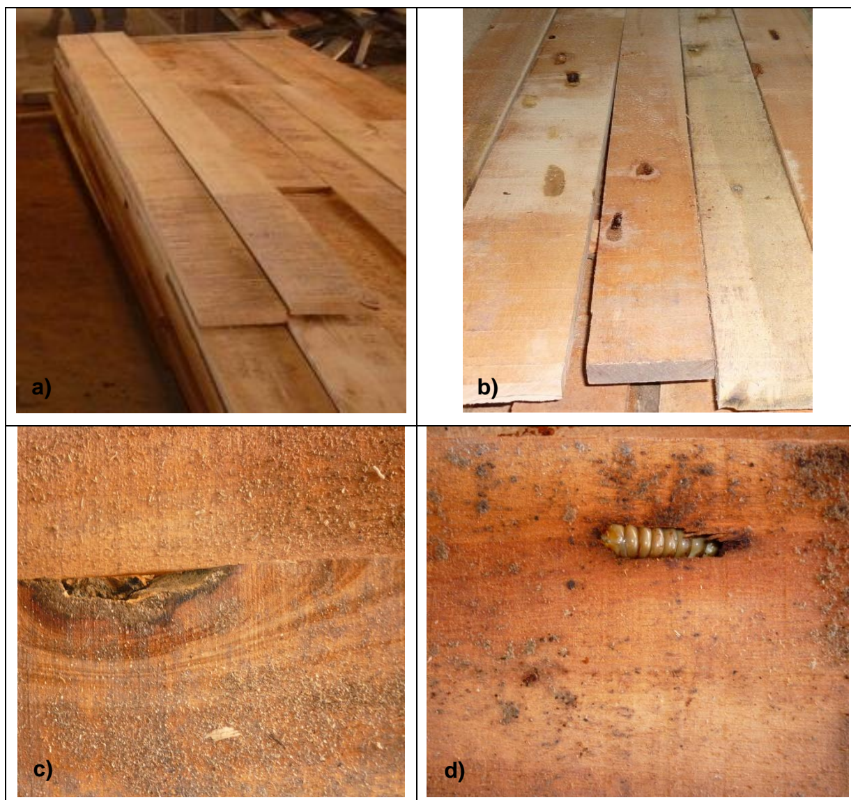
FIGURA 15 – Classificação das tábuas em primeira e segunda qualidade; a) Madeira de primeira qualidade; b) Madeira de segunda qualidade; c) Nó na madeira; d) Furo de broca FONTE: A autora
