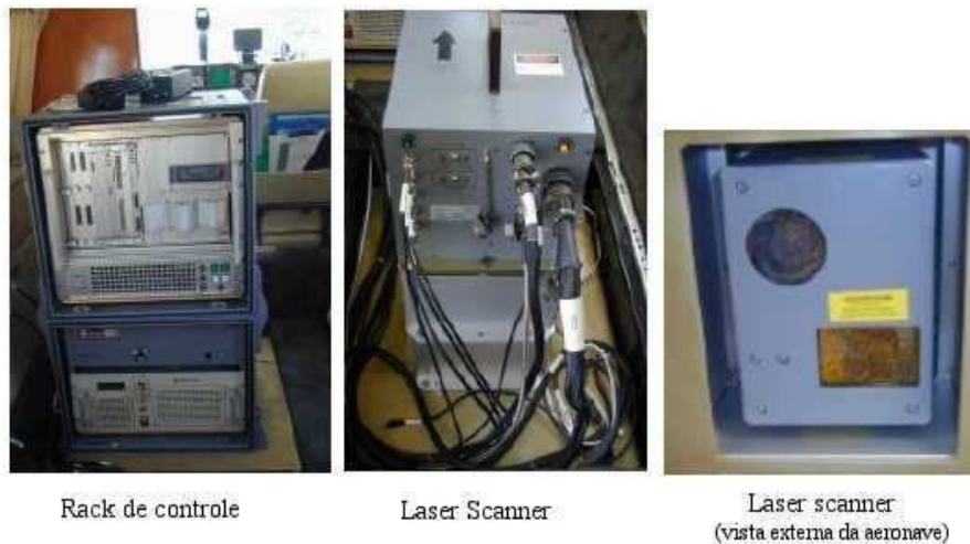
FIGURA 11 - EQUIPAMENTO OPTECH ALTM 2050
