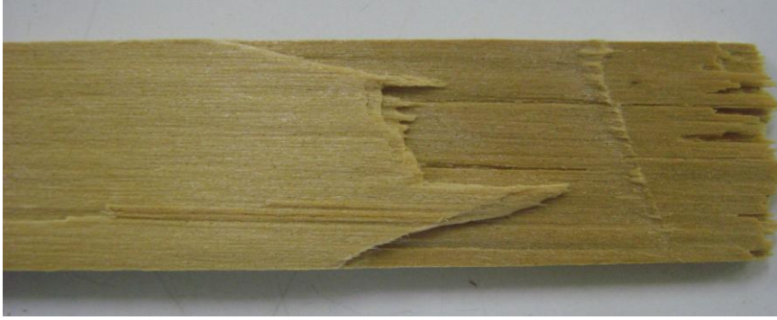
Figura 26 - Detalhe do cisalhamento sofrido pelos corpos-de-prova no ensaio de resistência ao impacto.
