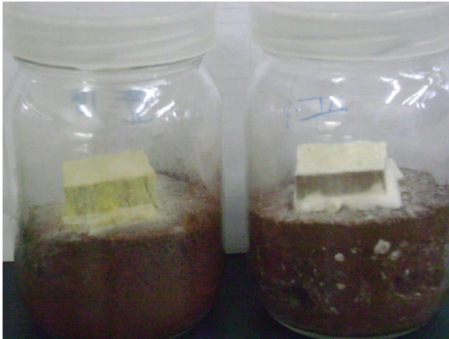
Figura 22 - Frascos de ensaio contendo corpos-de-prova do tratamento de combinação já em fase de finalização do experimento. À esquerda o fungo Gloeophyllum trabeum e à direita o fungo Trametes versicolor .
