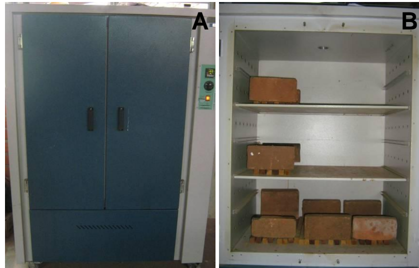
Figura 8 - Vista externa (A) e interna (B) da estufa utilizada no tratamento de termorreificação (Fonte: o autor).
