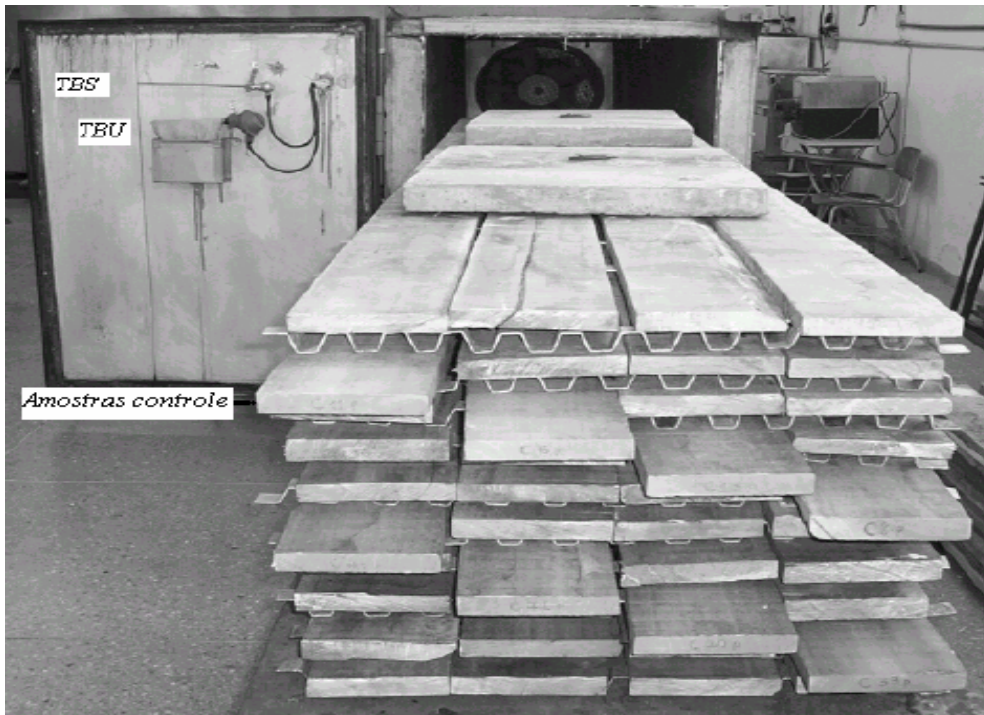
FIGURA 3: Empilhamento da madeira para secagem convencional em estufa piloto. (TBS = Termômetro de bulbo seco, TBU = termômetro de bulbo úmido).
