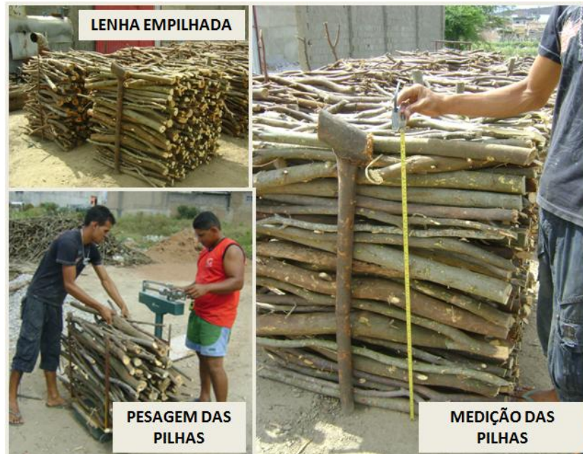
Figura 10: Empilhamento da lenha de Prosopis juliflora em estéreos, medição das pilhas com trena e pesagem em balança de plataforma
