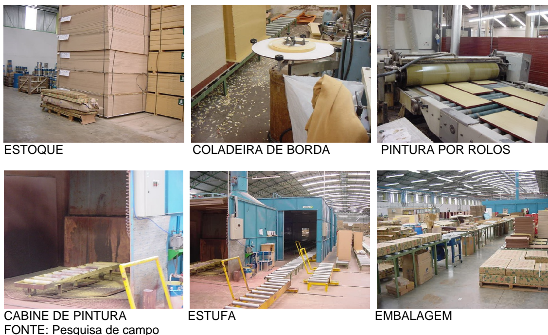
QUADRO 15 – PEQUENAS, MÉDIAS E GRANDES EMPRESAS DE MÓVEIS RETILÍNEOS E OS RESPECTIVOS MAQUINÁRIOS UTILIZADOS
