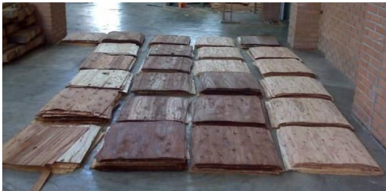
FIGURA 3 – LÂMINAS OBTIDAS NO PROCESSO DE LAMINAÇÃO
