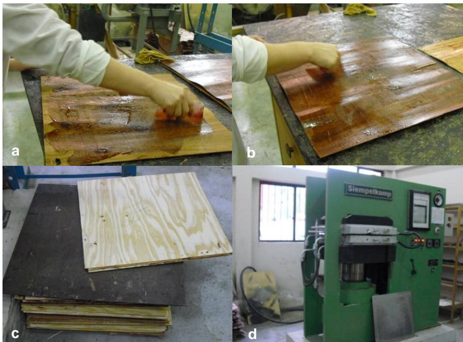
FIGURA 6 – PREPARAÇÃO DOS PAINÉIS COMPENSADOS
