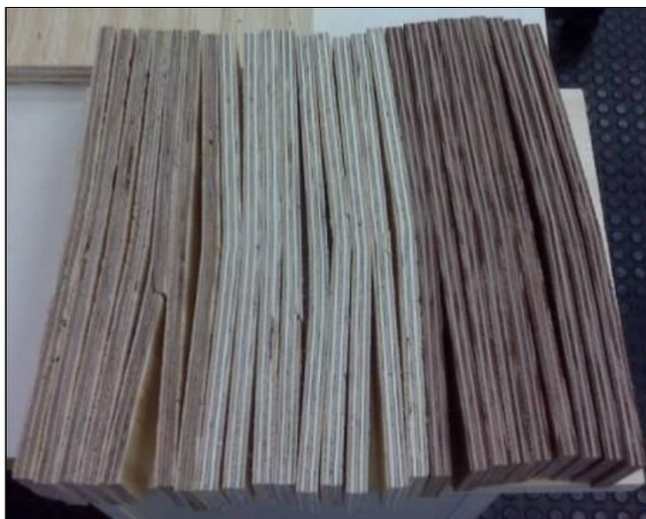
FIGURA 18 – CORPOS DE-PROVA DE FLEXÃO ESTÁTICA APÓS ENSAIO
