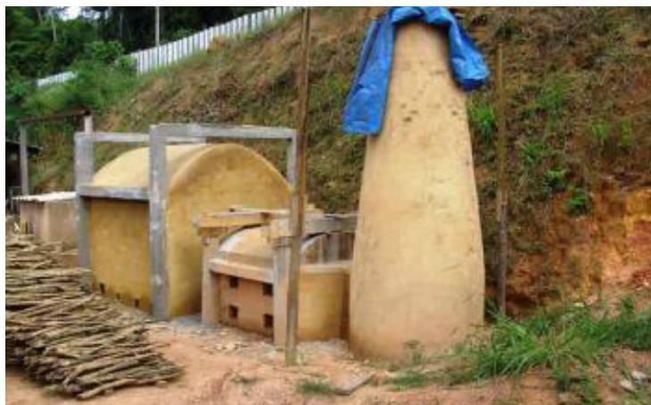
Figura 13. Sistema de carbonização dotado de queimador de fumaça para pequenos produtores de carvão vegetal.
