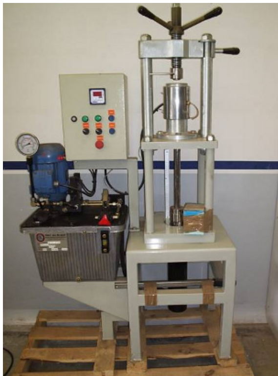
Figura 12. Briquetadeira laboratorial com desenvolvimento complementar junto ao LPF/SFB.
