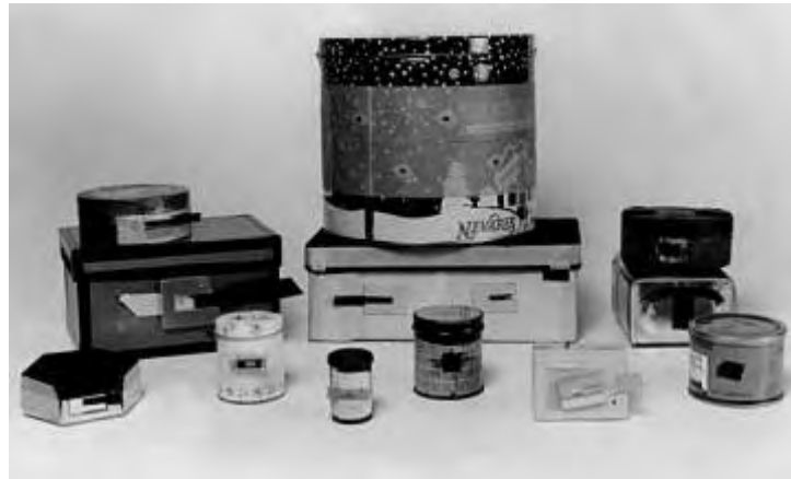
ALGUNS MODELOS DE CÂMERAS PINHOLE
