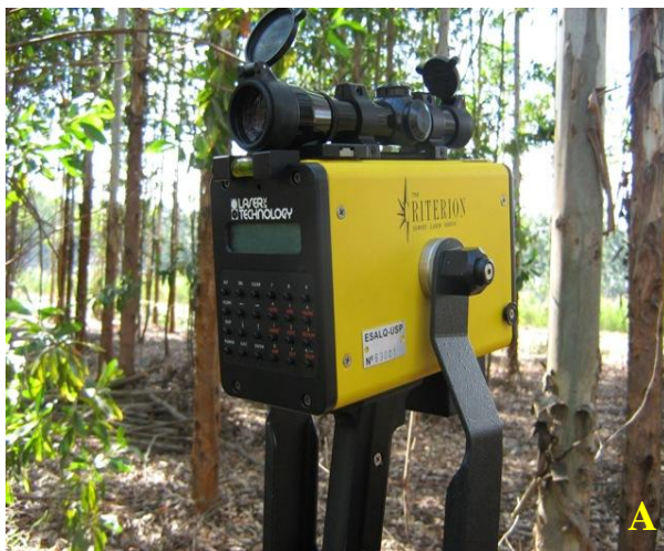
Figura 3.2 – Aparelhos utilizados para medições dos diâmetros a diferentes alturas. A) Criterion 400 e B) RC3H (Fonte: www.grube.ba ).
