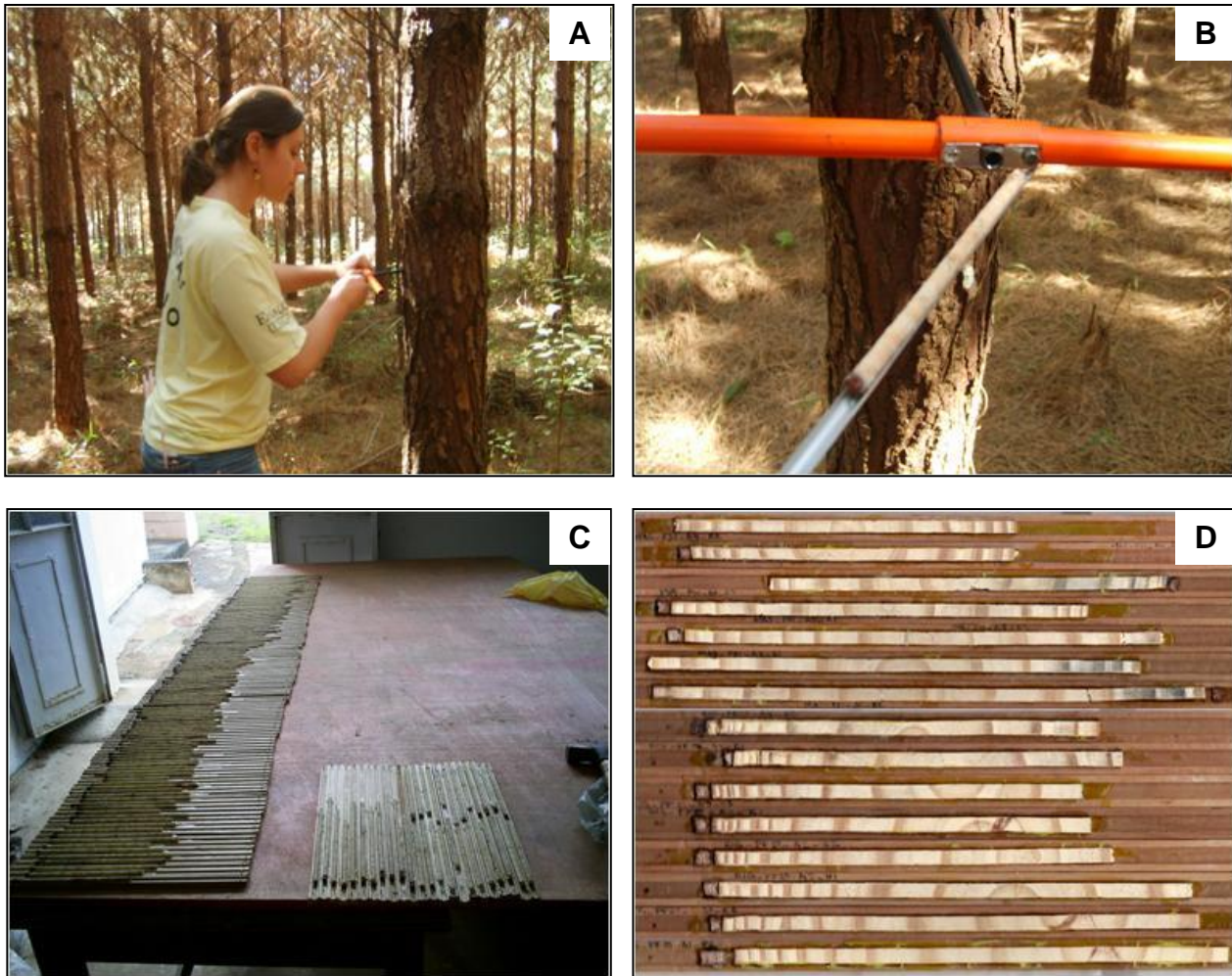
Figura 9 – Amostragem não destrutiva do lenho de Pinus taeda com sonda de Pressler. (A) Inserção da sonda em orientação perpendicular ao eixo da árvore. (B) Extração da amostra do lenho com auxílio de espátula. (C) Amostras coladas em suporte e fixadas em prancha de madeira para o polimento. (D) Amostras polidas e escaneadas para mensuração da largura dos anéis
