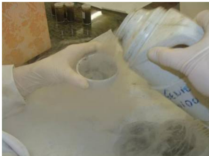
Figura 8 - Método de moagem com nitrogênio líquido
