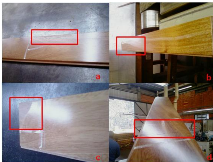
Figura 53 – Defeitos considerados para o atributo pisos de amendoim com falha no verniz, para a linha 2: a,b - ausência de verniz; c – coloração esbranquiçada; d – camada mais fina de verniz
