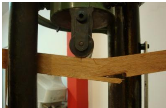
Tubo 4: Ruptura iniciada no corte e propagada por cisalhamento paralelo 3s fibras em dire3o a se3o de momento m3ximo e ruptura final por tens3es normais fora do meio do v3o
