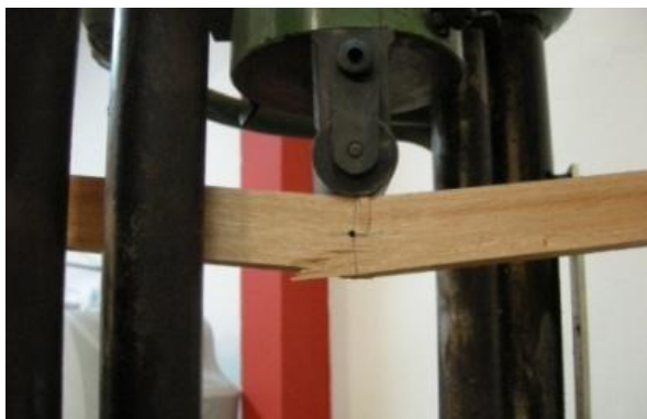
Tubo 1: Ruptura por tens3o normal na se3o transversal cr3tica (meio do v3o)
