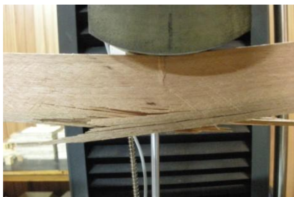
Tipo 1: Ruptura por tensão normal na seção transversal crítica (meio do vão)
