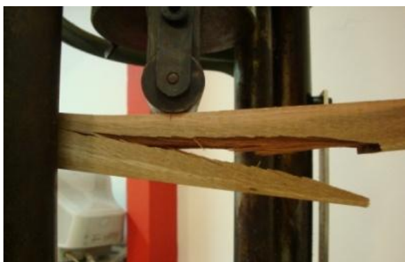
Tubo 5: Ruptura iniciada no corte e propagada por cisalhamento na dire3o da inclina3o anormal da gr3 que provou redu3o dr3stica da altura da viga
