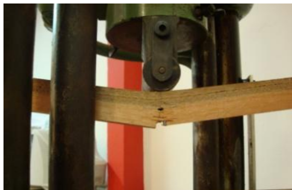
Tubo 2: Ruptura por tens3o normal na se3o transversal cr3tica reduzida (meio do v3o)
