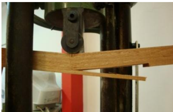
Tubo 3: Ruptura iniciada no corte e propagada por cisalhamento paralelo 3s fibras em dire3o a se3o de momento m3ximo e ruptura final por tens3es normais no meio do v3o
