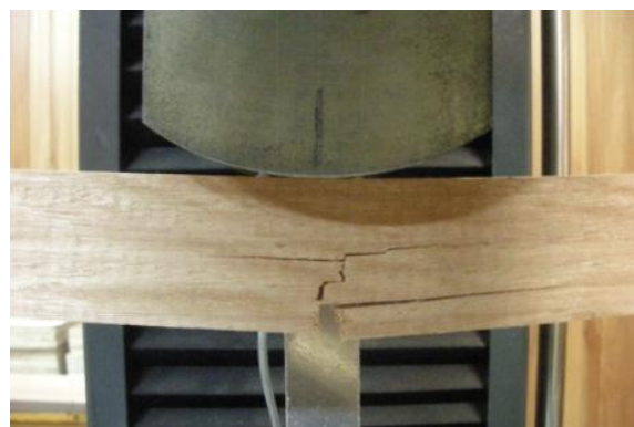
Tipo 2: Ruptura por tensão normal na seção transversal crítica reduzida (meio do vão)
