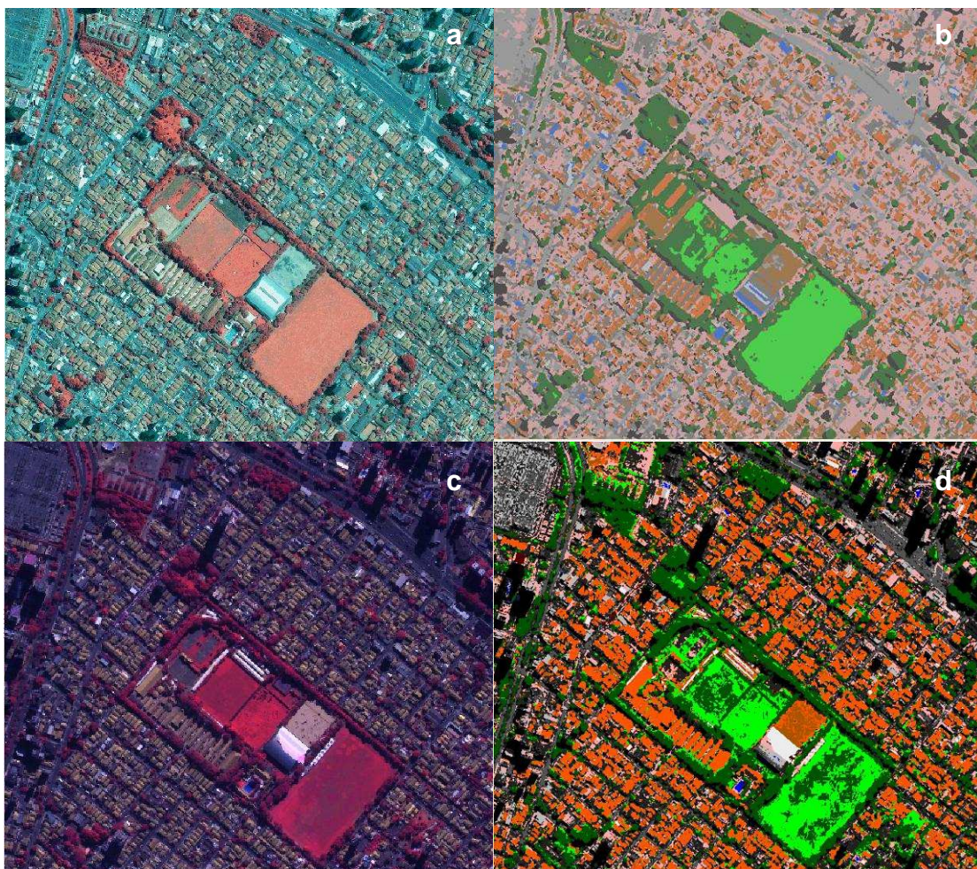
Figura 10 - Testes com o classificador de Máxima Verossimilhança: a) Recorte de imagem IKONOS do ano de 2002 da subprefeitura de Pinheiros; b) Recorte de imagem IKONOS classificada da subprefeitura de Pinheiros; c) Recorte de imagem Quickbird do ano de 2008 da subprefeitura de Pinheiros; d) Recorte de Imagem Quickbird classificada da subprefeitura de Pinheiros
