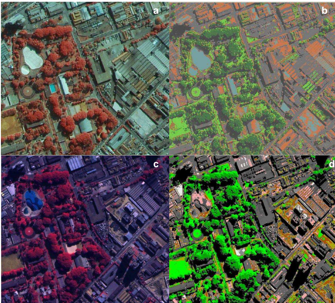
Figura 8 - Testes com o classificador ISODATA: a) Recorte de imagem IKONOS do ano de 2002 da subprefeitura da Moooca; b) Recorte de Imagem IKONOS classificada da subprefeitura da Moooca; c) Recorte de imagem Quickbird do ano de 2008 da subprefeitura da Moooca; d) Recorte de Imagem Quickbird classificada da subprefeitura da Moooca
