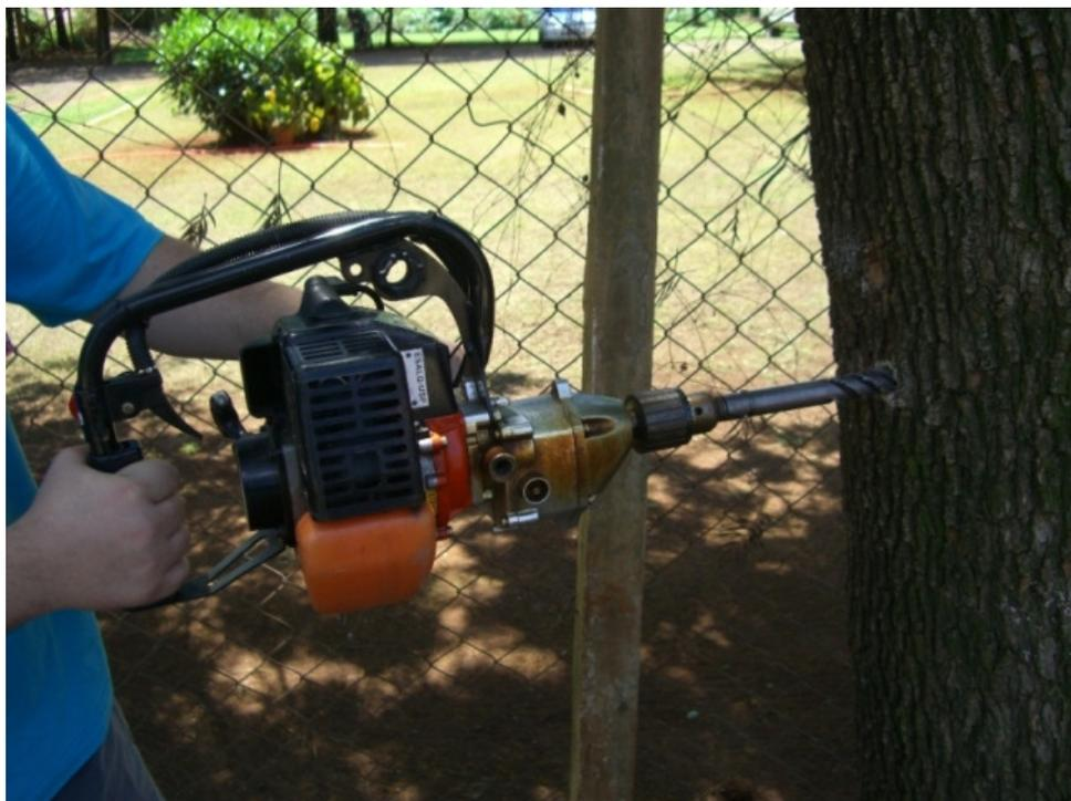
Figura 6 - Extrator motorizado-sonda metálica longa na coleta de amostras do lenho das árvores
