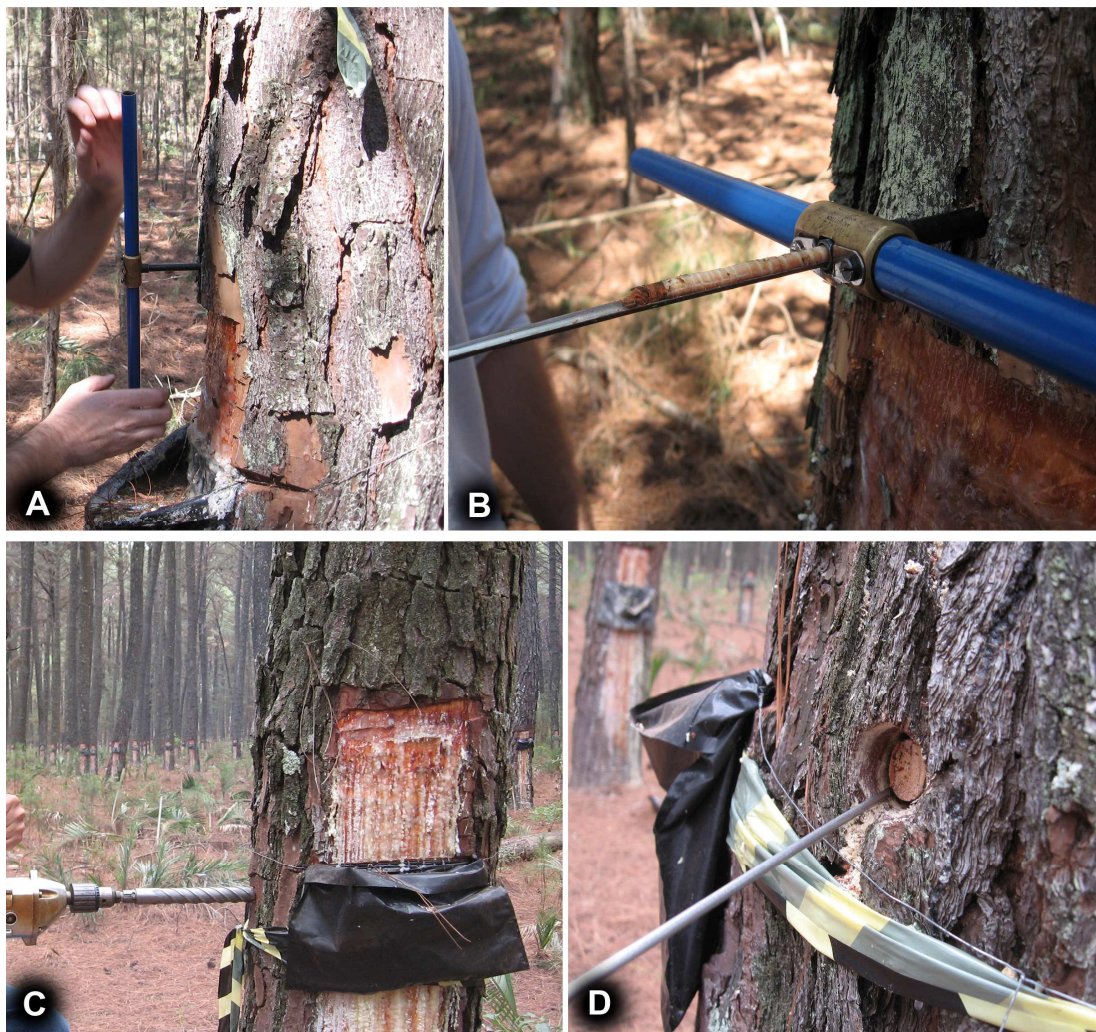
Figura 13 - Extração das amostras do lenho do tronco das árvores de Pinus caribaea var. hondurensis através de método não destrutivo. (A, B) extração com sonda de Pressler com 6 mm de diâmetro; (C, D) extração com sonda metálica e extrator motorizado, com 25 mm de diâmetro
