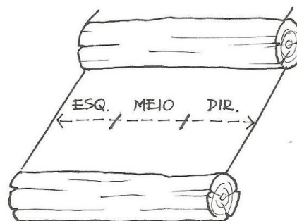
Figura 30 - Subdivisão da largura do piso do degrau
