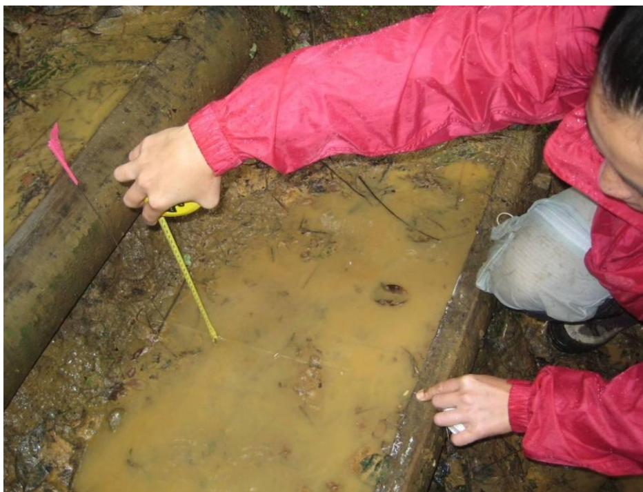
Figura 24 - Uso da bandeira com haste de metal e fio de náilon com marcação a cada 5 cm
