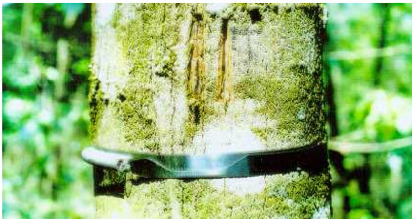
Figura 2 - Modelo de faixa dendrométrica acoplada no tronco da árvore
