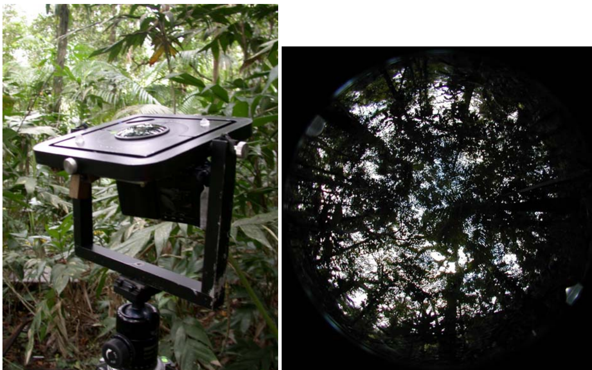
Figura 6 – Detalhe da mesa autoniveladora acoplada à máquina fotográfica (à esquerda) usada durante a tomada das fotografias hemisférica (à direita) e caracterização o regime de luz das parcelas avaliadas neste estudo. Além de um nível, a mesa possui também uma bússola acoplada que facilita a orientação da fotografia através do norte magnético marcado por um diodo emissor de luz (LED - no detalhe à direita)
